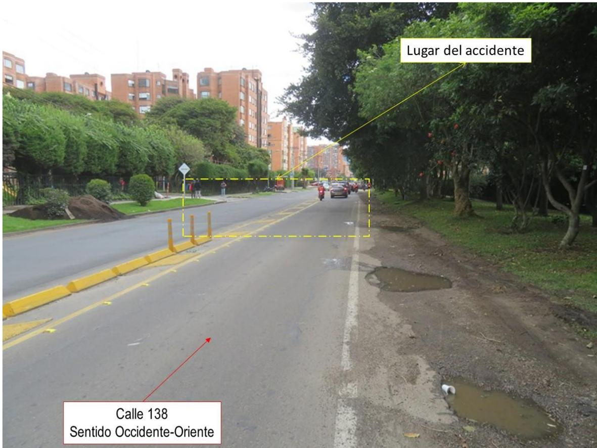
**Fotografía No.8 General:** Fotografía tomada sobre la calle 138 en sentido occidente- oriente, en aproximación al lugar de los hechos, donde se observan las características generales del tramo de vía, morfología, estado, demarcación y señalización. En este sentido se desplazaba el vehículo tipo camioneta.
