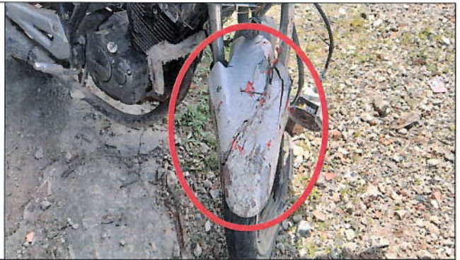
Imagen 4, se observa el guarda fango delantero destruido.
