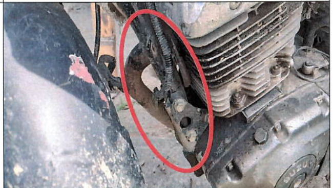
Imagen 8, se observa la diagonal del chasis destruida con desplazamiento hacia atrás.
