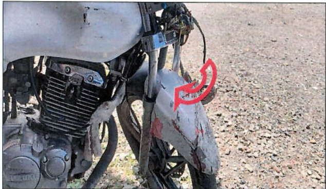
Imagen 3, se observan las barras telescópicas torcidas hacia atrás y giradas hacia la izquierda.
