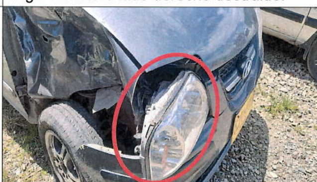
Imagen 6, se observa el conjunto de farola lado derecho destruida.
