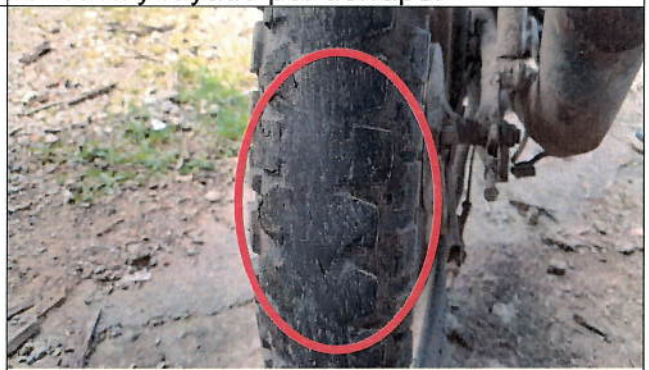
Imagen 14, se observa la llanta neumática trasera no presenta el labrado reglamentario en la cara rodante para la adherencia en el manto vial
