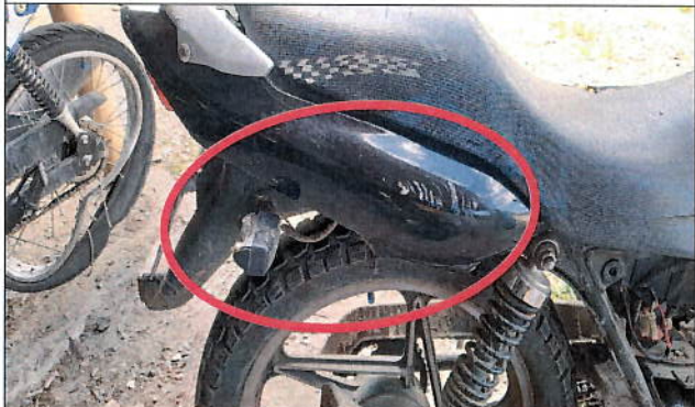
Imagen 13, se observa la carcasa lateral lado derecho rayada por derrape, la lente de la direccional trasera lado derecho destruida.
