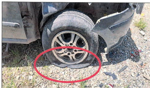
Imagen 3, se observa la llanta neumática delantera lado derecho estallada.
