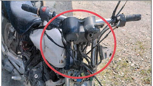
Imagen 6, se observan el tacómetro de velocidades, farola y direccionales delanteras destruidas.
