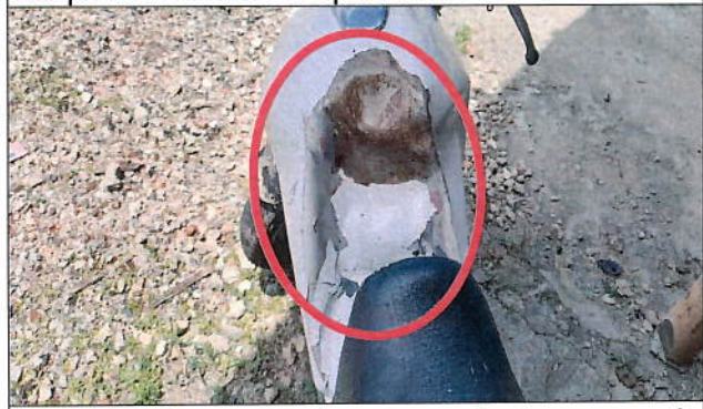
Imagen 9, se observa el tanque de combustible tercio posterior cara superior destruida con desprendimiento de pintura.
