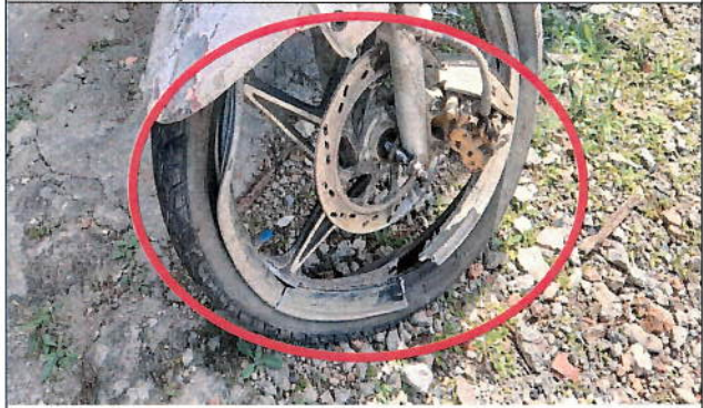
Imagen 5, se observan el rin de la rueda delantera, disco de frenado, el eje de la rueda y mordaza del frenado delantero destruido.
