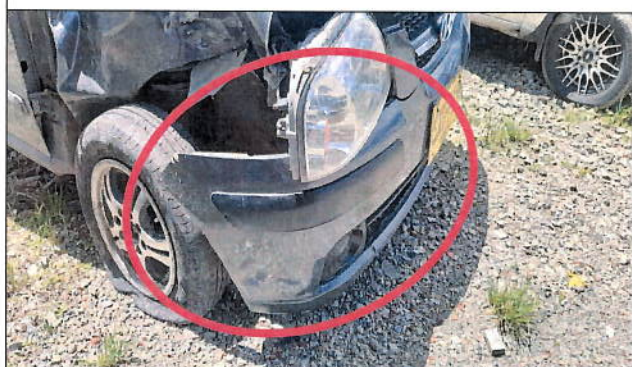
Imagen 5, se observa el bomper delantero lado derecho fisurado y desgrafado del punto de ajuste.
