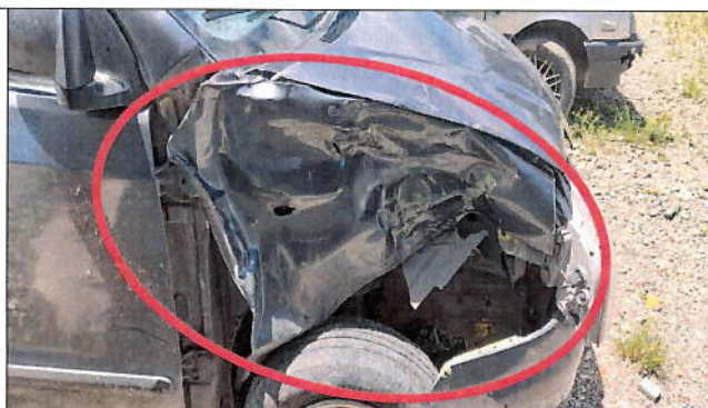
Imagen 4, se observa la nave del guardafango delantero lado derecho destruido.
