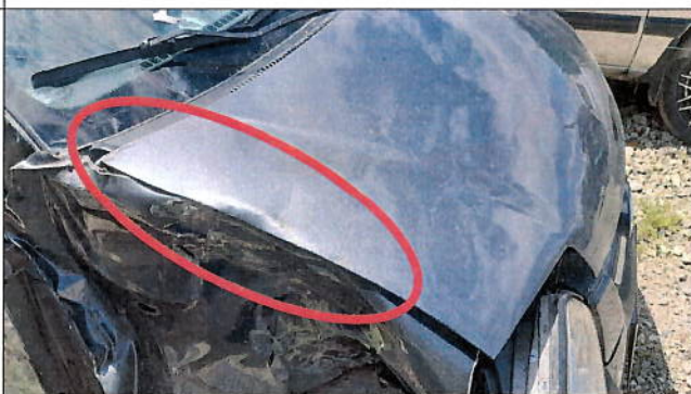
Imagen 8, se observa el capot lado derecho abollado en forma cóncava levemente, con desplazamiento hacia la izquierda.
