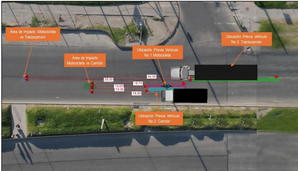
**Imagen No. 47:** En esta imagen, se observa el área de ubicación relativa entre los vehículos involucrados 1,2s y 1,5s antes del área de pérdida de control. Elaborada en el software Trimble Forensic Reveal
