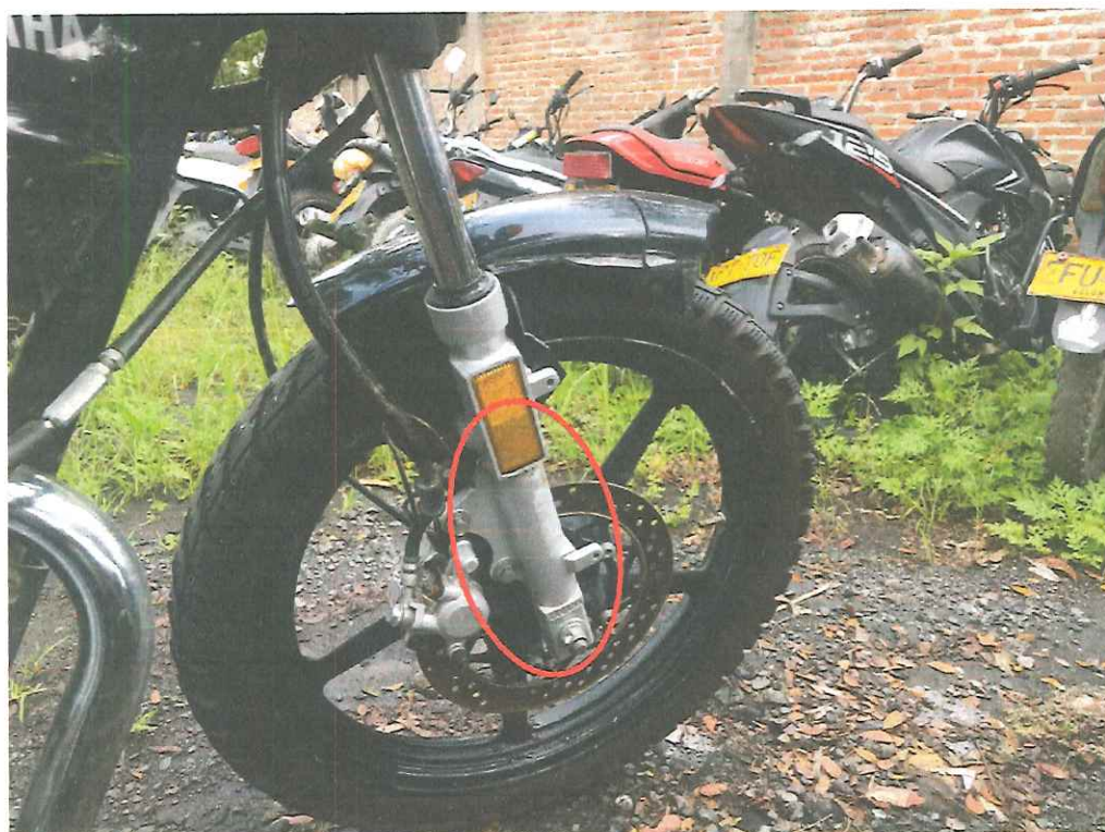
Botella de barra derecha con abolladuras leves y afectación de pintura.
