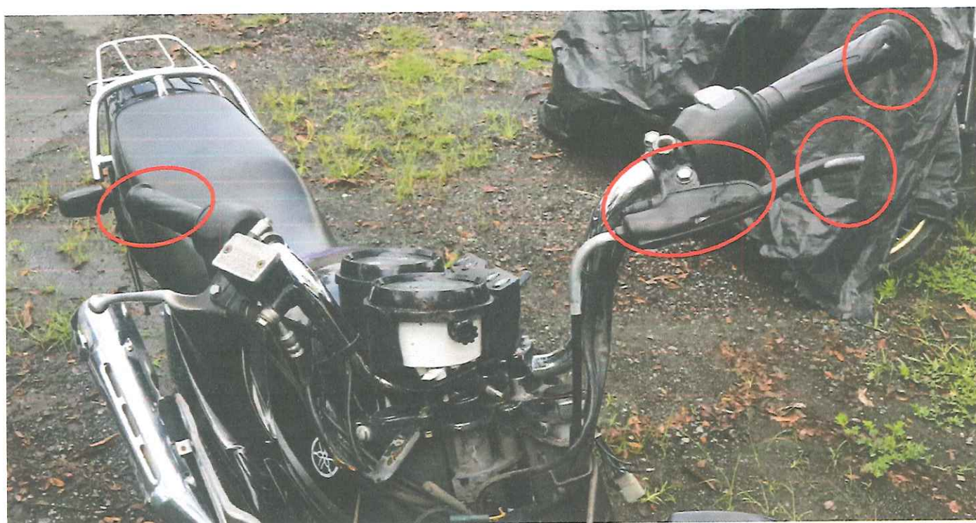
Manigueta del embrague destruida. Caucho protector manigueta lado izquierdo averiado. Caucho empuñadura lado derecho e izquierdo averiados.
