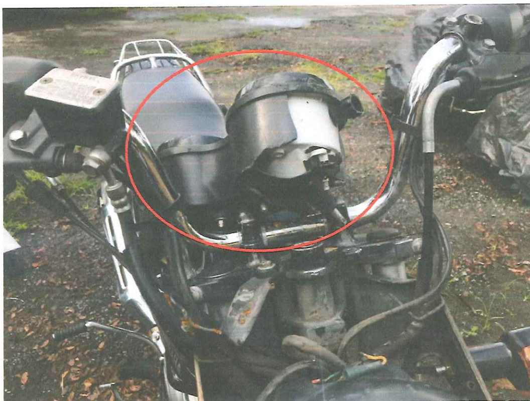
Tacómetro fuera de su sitio original por destrucción de la base respectiva.
