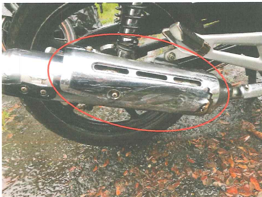
Tapa del exosto con abolladuras leves.
