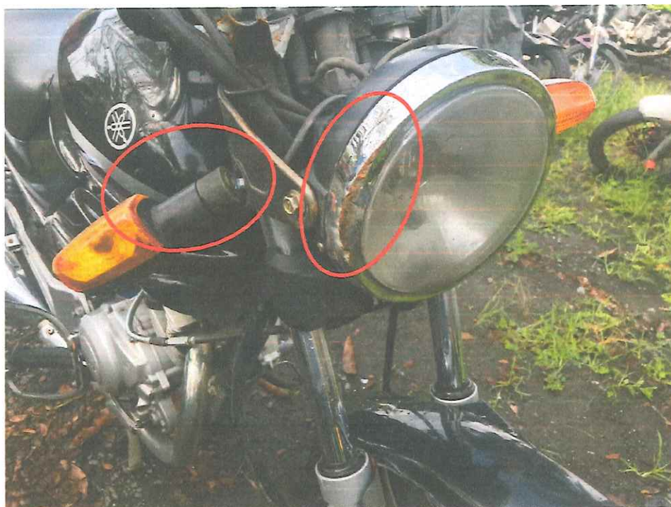
Aro de aluminio de la farola delantera con abolladuras profundas. Direccional delantero derecho averiado.
