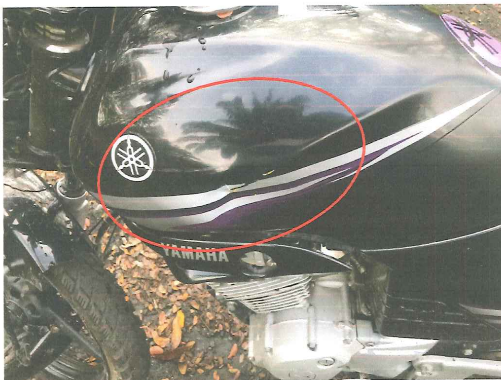
Tanque de almacenamiento de combustible con abolladuras y afectación de calcomanía y pintura en lado izquierdo.
