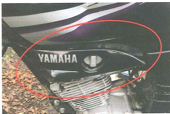
Cortavientos del tanque de almacenamiento de combustible lado derecho e izquierdo con desplazamiento de su sitio original.
