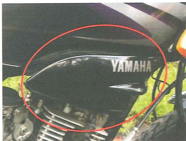
Cortavientos del tanque de almacenamiento de combustible lado derecho e izquierdo con desplazamiento de su sitio original.
