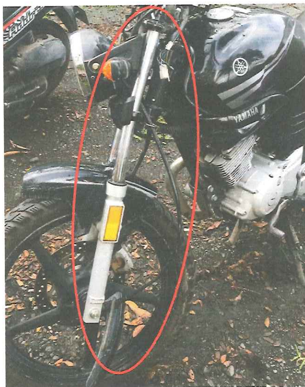
Guayas de velocímetro y revoluciones desprendidas.
