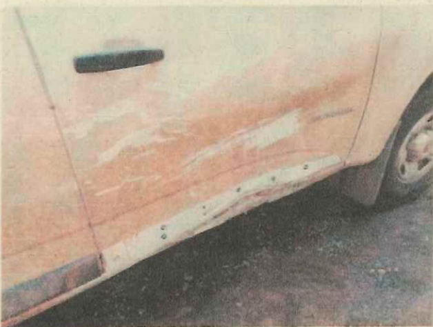
FOTO Nro. 9 Presenta sumidos en la puerta delantera derecha y daño el bisel.
