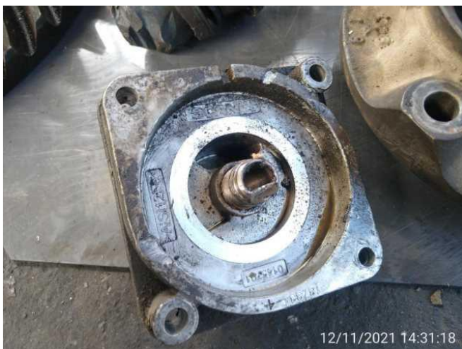
Imágenes No. 29 – 34. Verificación afectación filtro de aceite diferencial.
