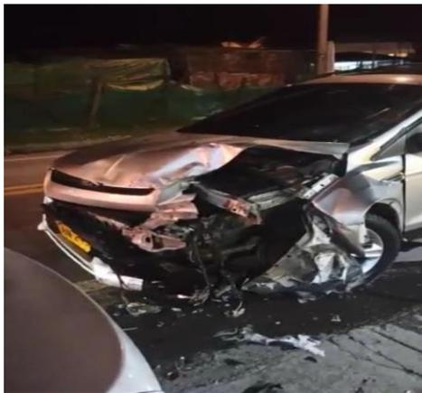
**Imagen No. 3 Primer Plano:** En esta fotografía se observan los daños presentes en el vehículo No. 1 camioneta (abolladura del capot, deformación zona anterior izquierda, desalojo del bómper y guardabarros).
