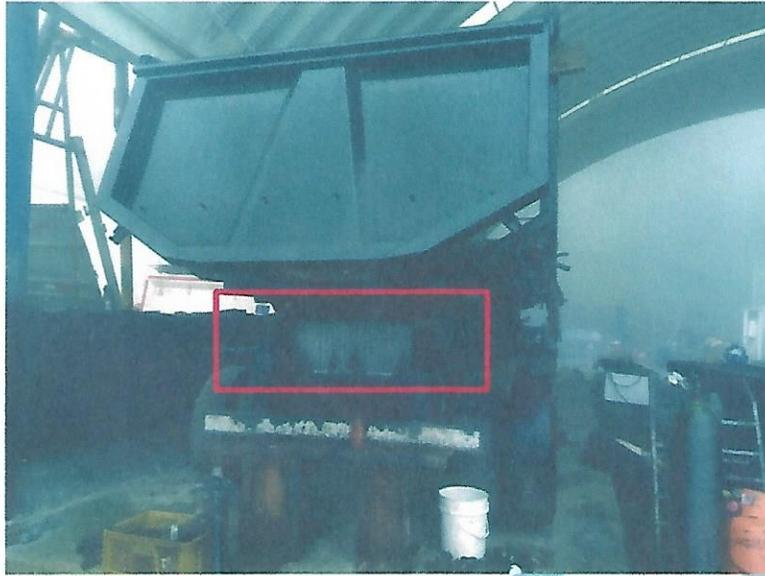
**COSTADO POSTERIOR:** Se evidencia el costado posterior del remolque con su respectivo volco en el lugar de intervención en el taller ya referido.  El recuadro rojo permite identificar el lugar donde va fijada normalmente la placa del tráiler, evidenciándose que fue retirada de dicho lugar.
