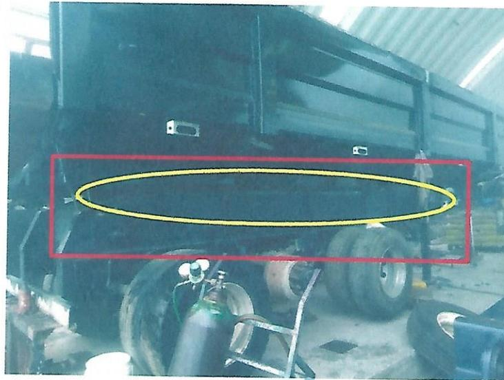
**COSTADO IZQUIERDO:** El registro fotográfico permite evidenciar que el costado lateral izquierdo del bastidor o chasis del remolque objeto de estudio, donde mediante el ovalo alargado de color amarillo se evidencia la intervención y fijación de láminas de hierro con soldadura de punto en su parte superior
