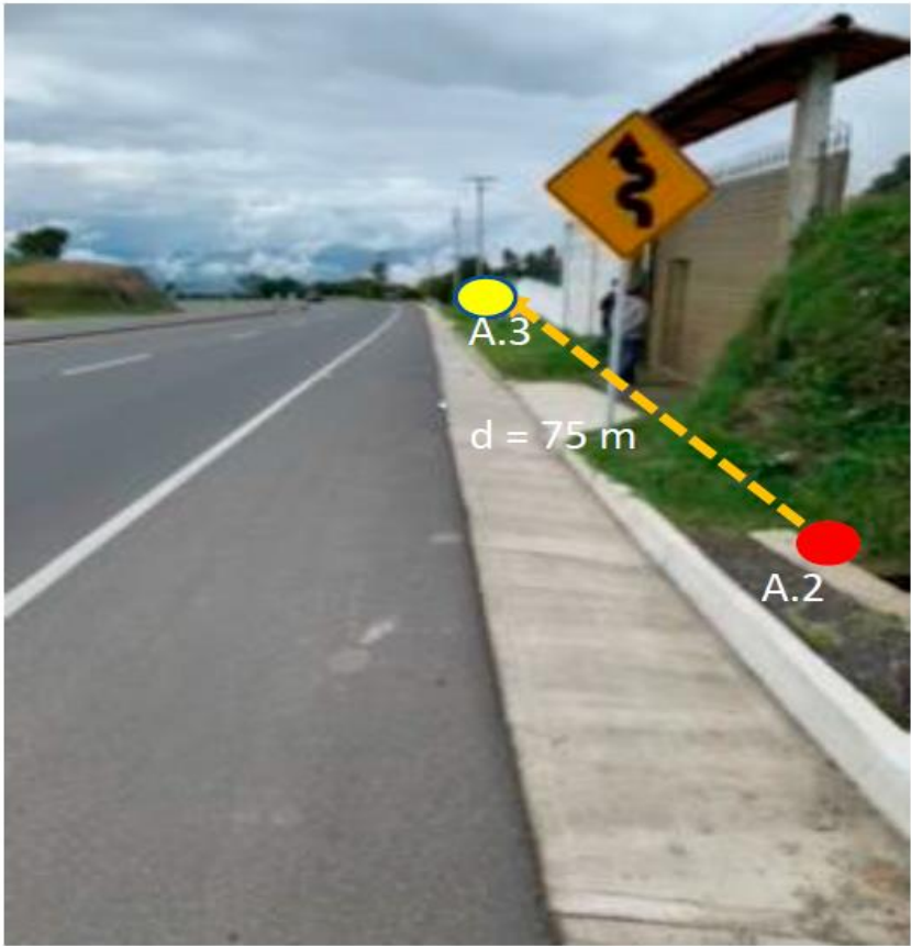
Foto 10. Ubicación tubería propuesta entre alcantarillas A.2 y A.3
