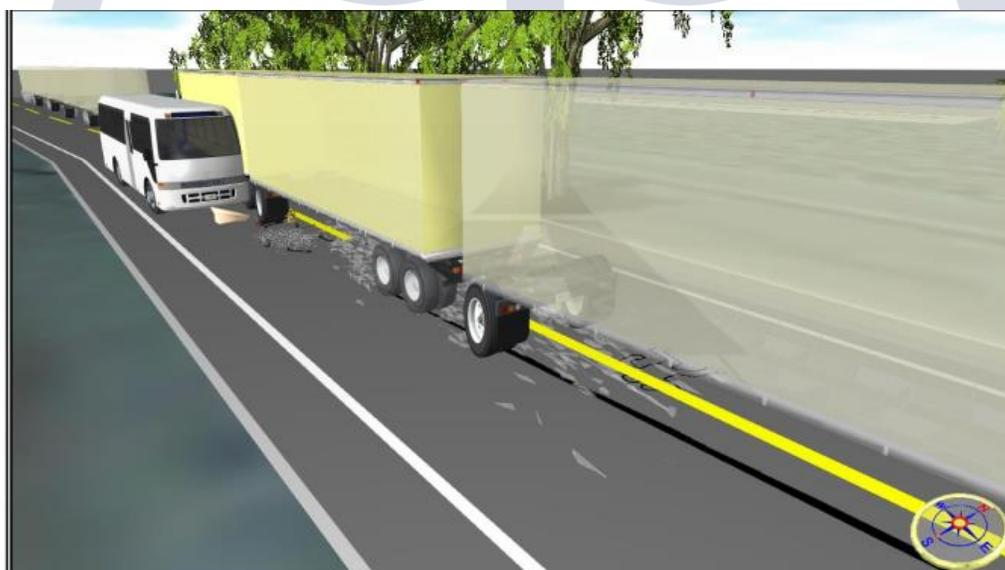
Imagen 10 Fuente software ARAS 360 HD, Reconstrucción y modelación Ing. Rommy Schnaider Cano, visual del instante de colisión. Topografía, plano y condiciones climáticas similares. Edición Ing. Rommy Schnaider Cano. Punto de impacto localizado por los daños presentes en los vehículos y elementos físicos en la vía. plano escala 1:1 desde la perspectiva de una visual. 1:100
