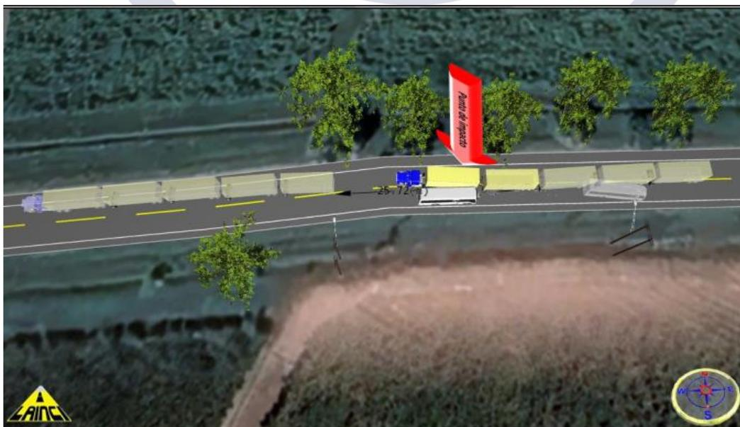
Imagen 06 Fuente software ARAS 360 HD, Reconstrucción y modelación Ing. Rommy Schnaider Cano, visual del instante de colisión y se evidencia área de choque en el primer y segundo tercio lateral izquierdo del bus. Topografía, plano y condiciones climáticas similares. Edición Ing. Rommy Schnaider Cano. Punto de impacto localizado por los daños presentes en los vehículos. plano escala 1:1 vista superior a 200 metros de altura.
