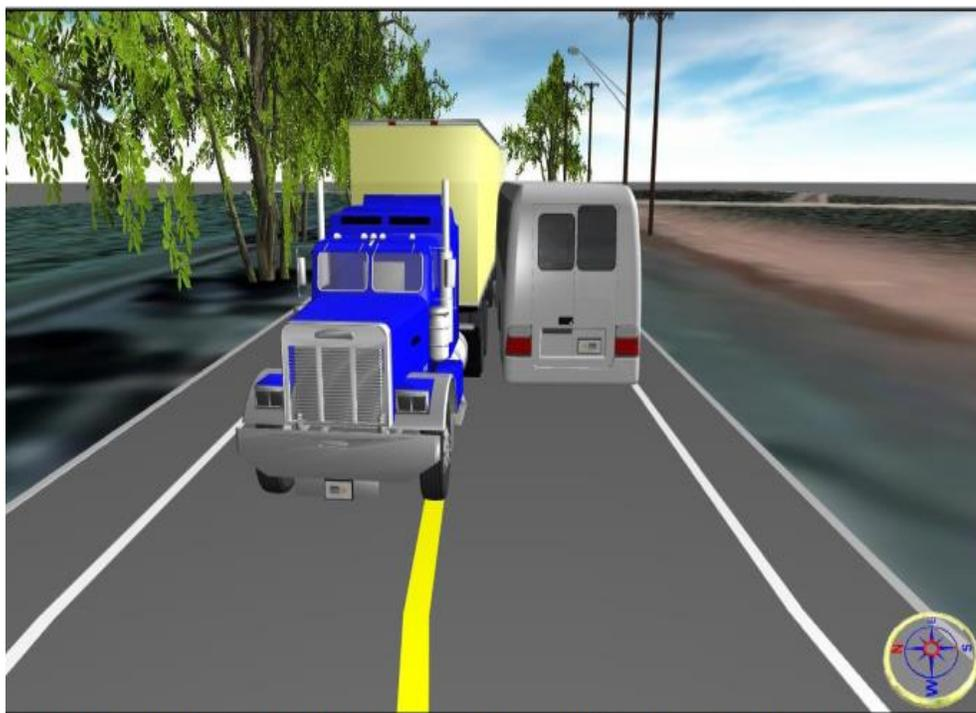
Imagen 09 Fuente software ARAS 360 HD, Reconstrucción y modelación Ing. Rommy Schnaider Cano, visual del instante de colisión. Topografía, plano y condiciones climáticas similares. Edición Ing. Rommy Schnaider Cano. Punto de impacto localizado por los daños presentes en los vehículos. plano escala 1:1 desde la perspectiva de una visual. 1:100
