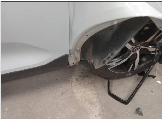
Imagen #. Y #. Se aprecia daños en el guardafangos delantero derecho y activación del sistema de seguridad airbags frontales.
