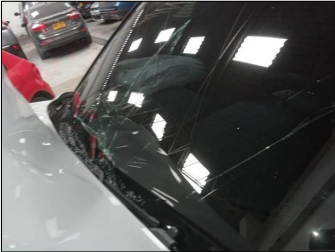
Imagen #. Y #. Se observa daño en el capó del vehículo asegurado, el cual a su vez causó la fractura del vidrio panorámico principal.
