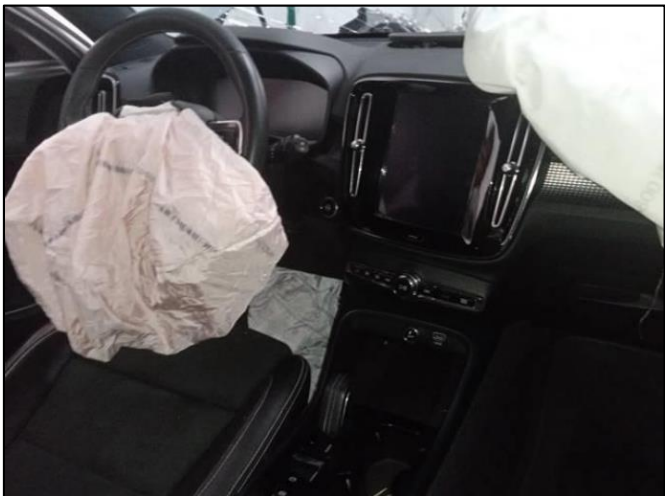
Imagen #. Y #. Se aprecia daños en el guardafangos delantero derecho y activación del sistema de seguridad airbags frontales.
