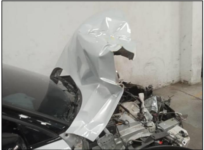
Imagen #. Y #. Se observa daño en el capó del vehículo asegurado, el cual a su vez causó la fractura del vidrio panorámico principal.
