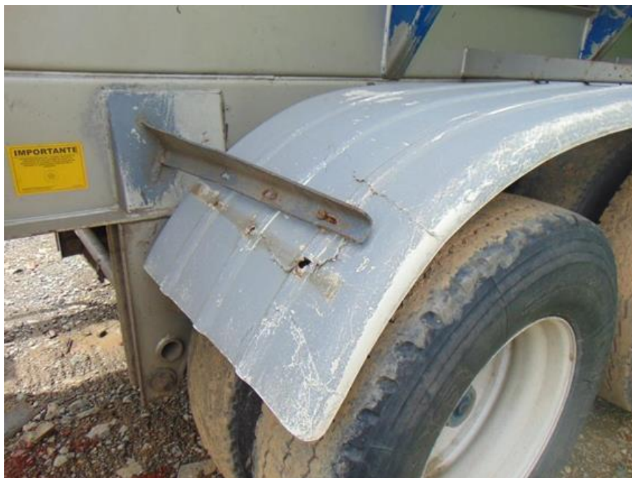
Fotografías No. 9 y 10: En estas fotografías se aprecia desajuste y deformación del guardafangos posterior izquierdo del semirremolque.
