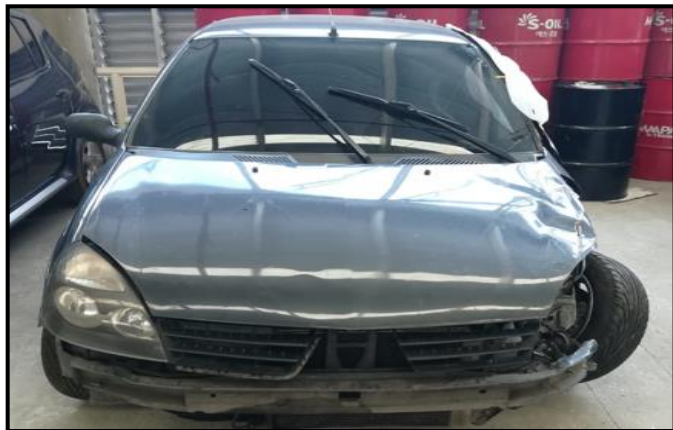
Imagen No. 03. PLANO MEDIO: La imagen muestra la parte frontal del vehículo asegurado de placas HKW-391, se evidencia la afectación que presenta en el bómper, persiana, radiador, soporte del radiador, capó, llanta y eje de llanta delantera izquierda ( Fotografía obtenida en diligencia de inspección ocular al vehículo en el taller Andar Excelencia del municipio de Envigado ).
