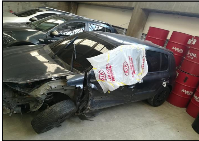
Imagen No. 06. PLANO MEDIO: La imagen muestra la parte lateral izquierda del vehículo asegurado de placas HKW-391, se evidencia la afectación que presenta en el bómper, persiana, radiador, soporte del radiador, capó, llanta y eje de llanta delantera izquierda, puertas y paral izquierdo ( Fotografía obtenida en diligencia de inspección ocular al vehículo en el taller Andar Excelencia del municipio de Envigado ).
