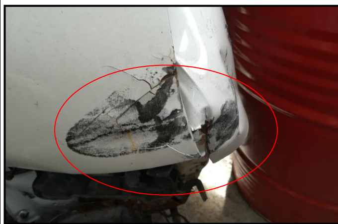
Imagen No. 18. DE DETALLE: La imagen muestra los residuos de pintura gris dejados en la parte frontal izquierda del vehículo tercero involucrado de QAG-009, después de impactar con la parte delantera izquierda del vehículo asegurado (Fotografía obtenida en diligencia de inspección ocular al vehículo tercero involucrado, en una bodega ubicada en la Diagonal 52 No. 10-177 municipio de Bello ).
