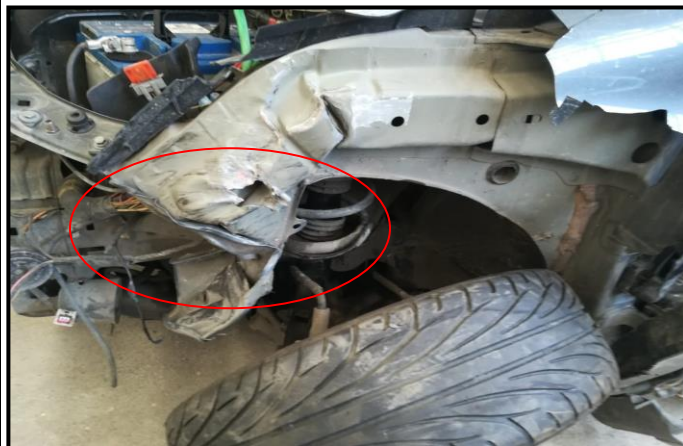
Imagen No. 08 DE DETALLE: La imagen muestra la parte donde se presentó mayor afectación al vehículo asegurado de placas HKW-391, se evidencia daños que comprometen, el bómper, llanta y eje de llanta delantera izquierda, persiana, radiador, soporte del radiador, ( Fotografía obtenida en diligencia de inspección ocular al vehículo en el taller Andar Excelencia del municipio de Envigado ).
