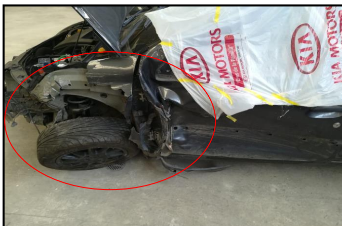
Imagen No. 07 . PLANO MEDIO: La imagen muestra la parte delantera izquierda del vehículo asegurado de placas HKW-391, se evidencia la afectación que presenta en el bómper, llanta y eje de llanta delantera izquierda, puertas y paral izquierdo persiana, radiador, soporte del radiador, capó, ( Fotografía obtenida en diligencia de inspección ocular al vehículo en el taller Andar Excelencia del municipio de Envigado ).
