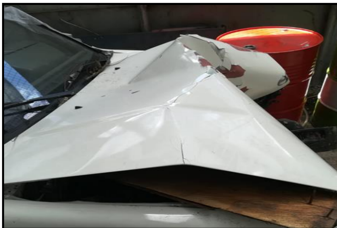
Imagen NO. 17. PLANO MEDIO: La imagen muestra los daños presentados en el capó del vehículo tercero involucrado de QAG-009 (Fotografía obtenida en diligencia de inspección ocular al vehículo tercero involucrado, en una bodega ubicada en la Diagonal 52 No. 10-177 municipio de Bello ).
