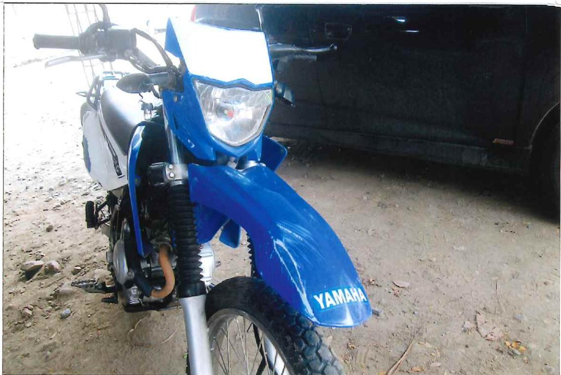
**FOTOGRAFÍA DEL PUNTO DE IMPACTO: PRESENTA PARTE DELANTERA DE LA MOTOCICLETA: RIN Y GUARDA FANGO, PRESENTA GOLPE EN EL RIN DELANTERO Y EL CARENAJE.**
