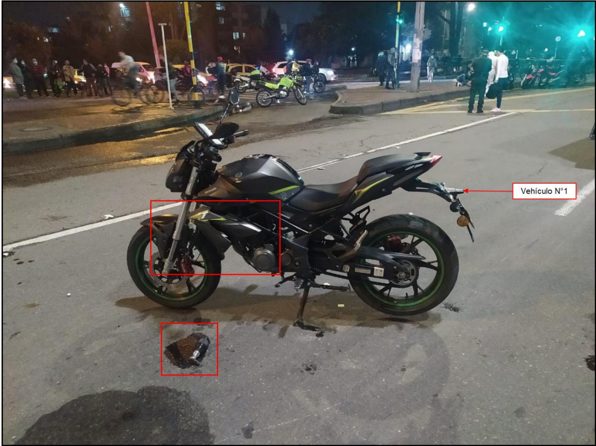
FOTOGRAFÍA N° 9 PLANO GENERAL: En esta fotografía se observan los daños presentes en el vehículo N°1, abrasiones costado lateral izquierdo, desprendimiento y desalojo del espejo izquierdo y el exlíder izquierdo
