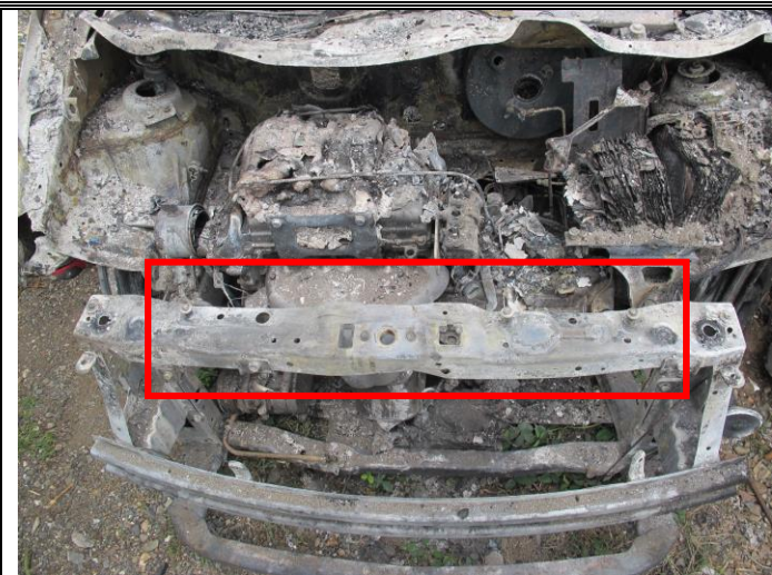
Imagen 06: muestra el puente frontal donde se ubica la plaqueta que contiene la serie de chasis.
