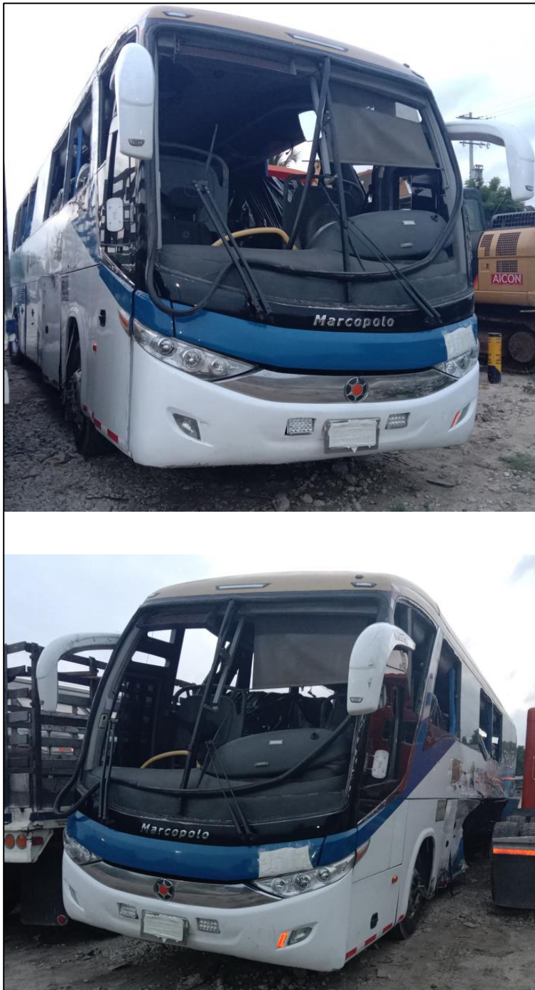
Imagen No.13: En esta imagen se aprecia el estado final del bus, el cual se evidencia daños en todo el rodante.
