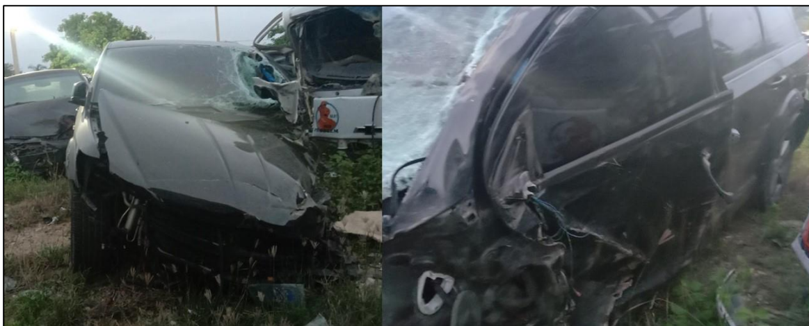
Imagen No.9: En esta imagen se aprecia el estado final de la camioneta, el cual presenta daños en la parte delantera y lateral izquierda.
