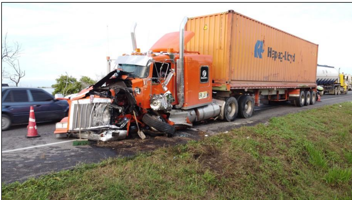
Imagen No.17: En esta imagen se aprecia el estado final del tractocamión, el cual se evidencia daños en la parte frontal y lado izquierdo.
