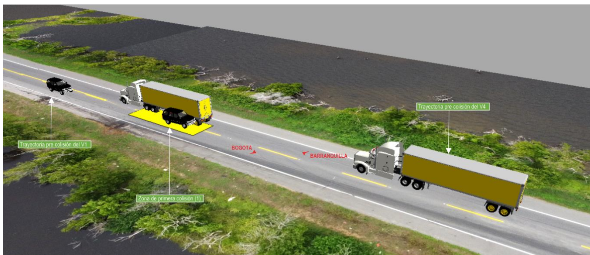
Imagen No.31: En esta imagen en vista 3D, se esquematiza las trayectorias pre-colisión de los vehículos protagonistas de la primera colisión.
