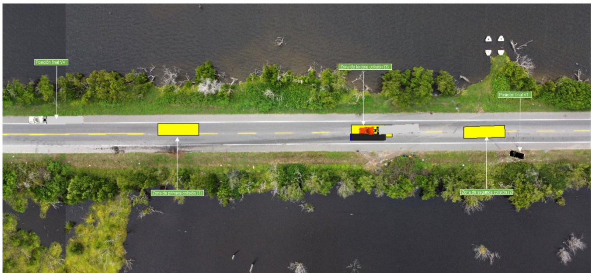
Imagen No.36: En esta imagen en vista planta, se esquematiza la zona donde se produce la tercera colisión, de la que fueran protagonistas el tractocamión (V3) y el bus (V2), también se diagrama la posición final adquirida por V4 y V1.
