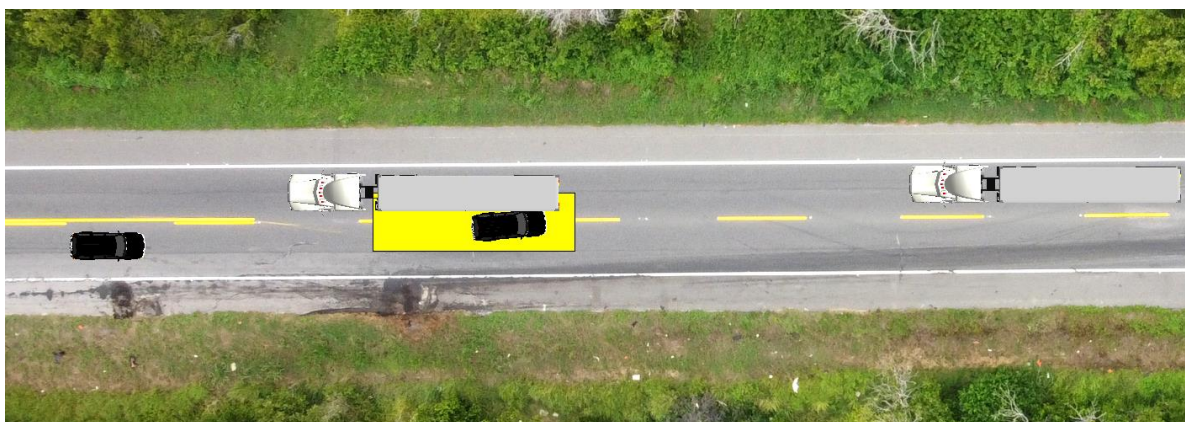
Imagen No.32: En esta imagen en vista planta, se esquematiza las trayectorias pre-impacto y la zona donde se produce la colisión entre los dos primeros vehículos (V1 y V3).
