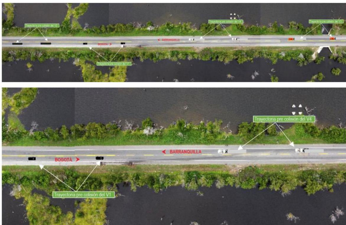
**Imagen No.30:** En esta imagen en vista planta, se esquematiza las trayectorias pre-colisión de los vehículos y las posiciones que tenían sobre la calzada en los instantes previos.
