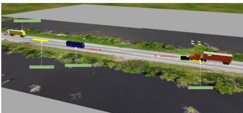
**Imagen No.35:** En esta imagen en vista 3D, se esquematiza las trayectorias pre-impacto y la zona donde se produce la colisión entre los vehículos (V1 y V3), también se diagrama la trayectoria post colisión del V4 y la pre-colisión del V2.
