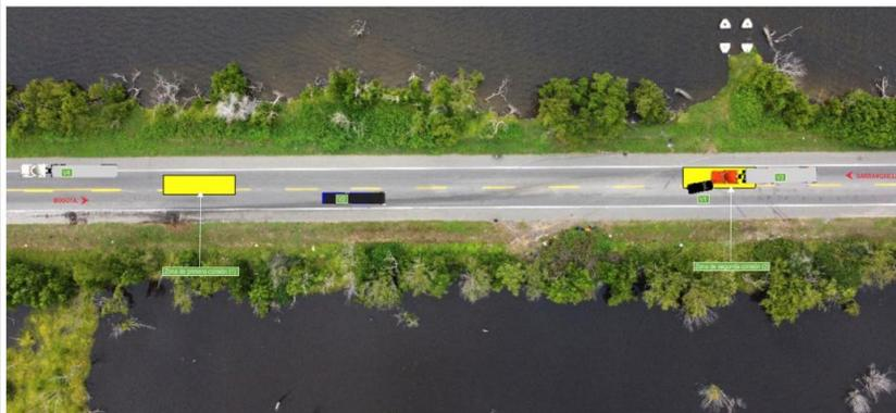
**Imagen No.34:** En esta imagen en vista planta, se esquematiza las trayectorias pre-impacto y la zona donde se produce la colisión entre los vehículos (V1 y V3), también se diagrama la trayectoria post colisión del V4 y la pre-colisión del V2.
