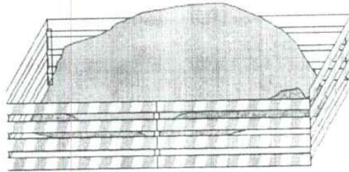
Figura 3. Señalización de escombros o acopio de material
