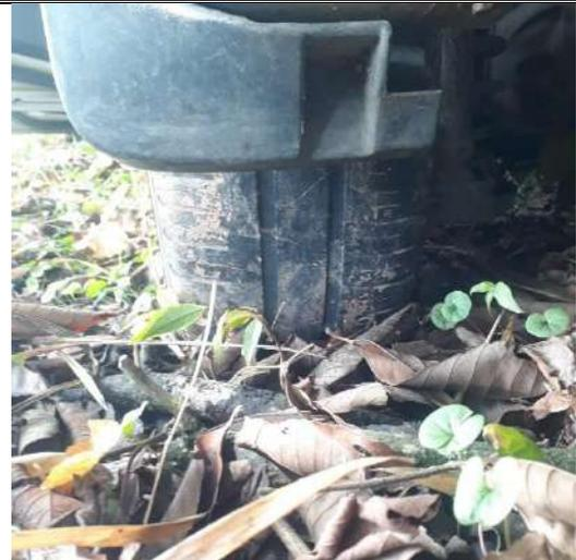
**Fotografía número 35 en primer plano:** En esta imagen se observa el labrado de la llanta posterior izquierda del vehículo de placas **KIM-195**: Llanta tipo neumática, Según el profundímetro el labrado de la llanta es de 4.3mm, en buen estado.
