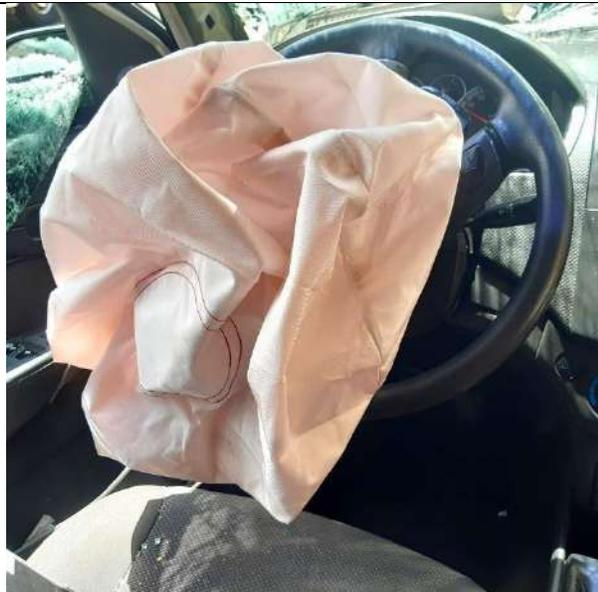
**Imagen N° 8:** En esta imagen se observa el volante del vehículo clase Automóvil se evidencia activación de la bolsa de aire: Conjunto en mal estado.
