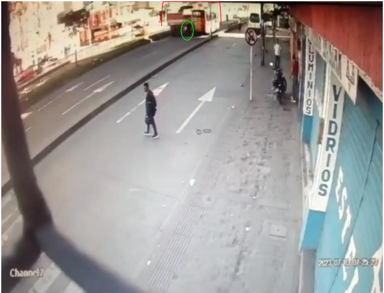
Fotograma N° 12: En esta imagen se observa el vehículo N° 1: Buseta la cual se encuentra detenida por completo sobre el carril derecho de la calzada, misma forma se aprecia el tránsito de una volqueta la cual se moviliza por el carril izquierdo de la calzada, el corchete de color rojo indica que los dos vehículos ocupan los dos carriles de circulación, el ovalo de color verde indica el choque del vehículo N° 2: Motocicleta con el vehículo N° 1: Buseta.
