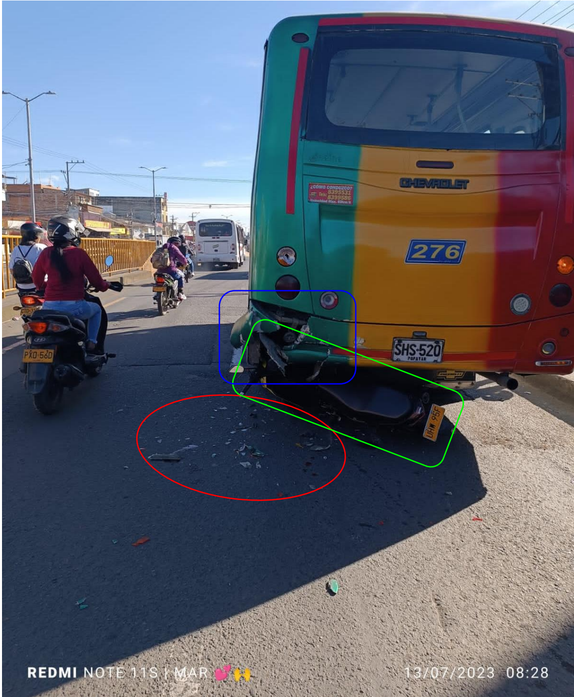
En esta imagen se observa la posición final del vehículo N° 1: Buseta, con daños en el vértice de posterior izquierdo de la carrocería, se aprecia además el vehículo N° 2 Motocicleta la cual se encuentra en la parte inferior de la buseta con volcamiento lateral izquierdo indicado con el recuadro de color verde, el ovalo de color rojo indica el desprendimiento de fragmentos por la colisión entre los dos vehículos, el recuadro de color azul indica rotura del vértice posterior izquierdo del bomper.
