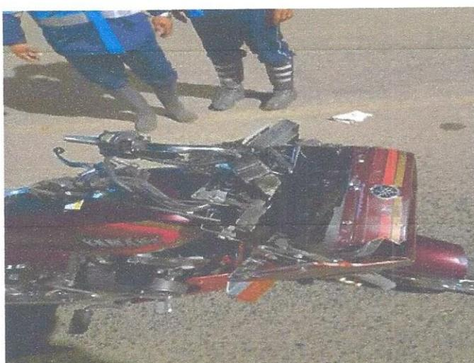
Imagen No. 4: Imagen PRIMERISIMO PRIMER PLANO: Parte frontal, motocicleta de placas MMI -92, deformación en manijas; rotura en carenaje; rotura en farola.
