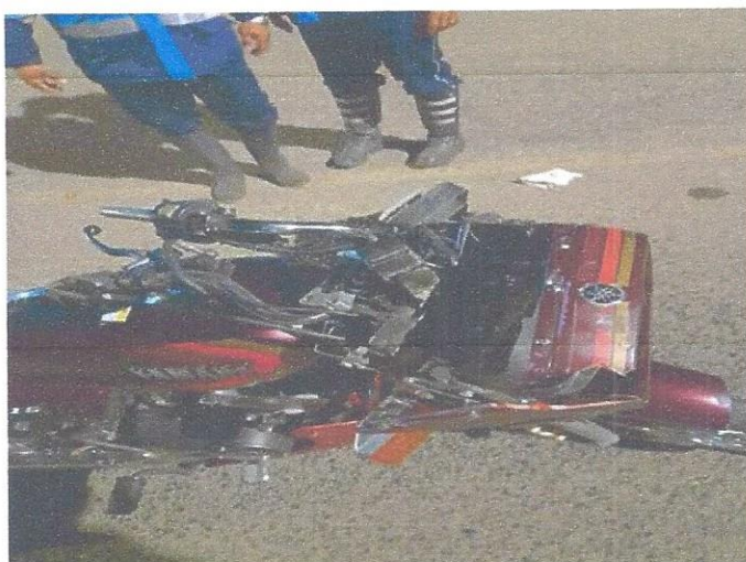
Imagen No. 4: Imagen PRIMERISIMO PRIMER PLANO: Parte frontal, motocicleta de placas MMI -92, deformación en manijas; rotura en carenaje; rotura en farola.
