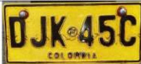
En esta imagen se observa la placa posterior de la matrícula del automotor DJK 45C, la cual corresponde a la diferenciación de las demás de su clase y tipo, posee el aluminio, la cinta reflectiva, troquelados, cortes y demás, que cumple con la ficha técnica 001 del ministerio de transporte, conjunto en buen estado
