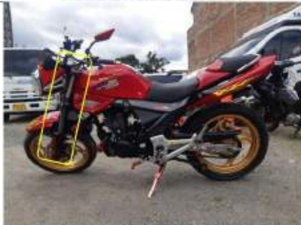
En esta imagen se observa la parte lateral izquierda de la motocicleta, donde se aprecia deformación del sistema de suspensión tipo barras
