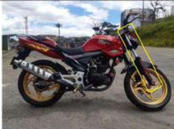
En esta imagen se observa la parte lateral derecha de la motocicleta, donde se aprecia deformación del sistema de suspensión tipo barras
