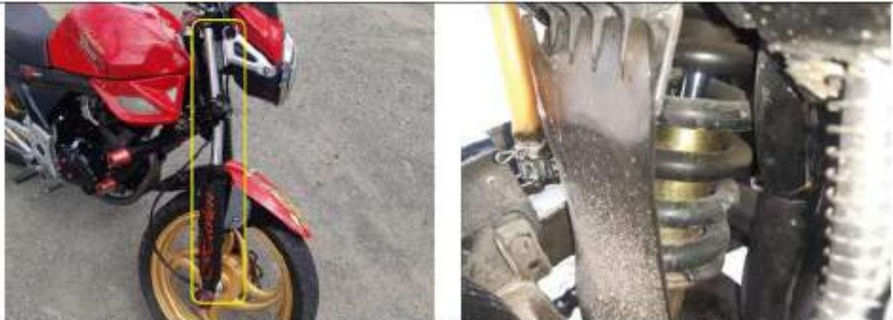
En esta imagen se observa el sistema de suspensión anterior tipo barras, donde se aprecia deformación de las mismas: Conjunto en mal estado
