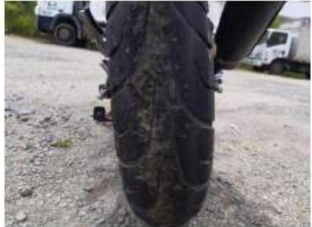
En estas imágenes se observa la llanta anterior y posterior, al igual que su respectivo labrado: Conjunto en buen estado
