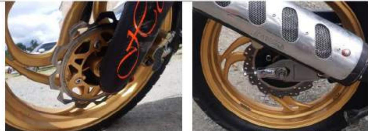
En estas imágenes se observa el sistema de frenos anterior y posterior tipo disco: Conjunto en buen estado
