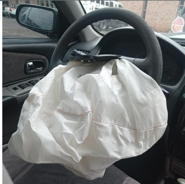
Imagen N° 13: En esta imagen se observa el volante del vehículo clase Automóvil, se aprecia activación de la bolsa de aire: Conjunto en mal estado.
