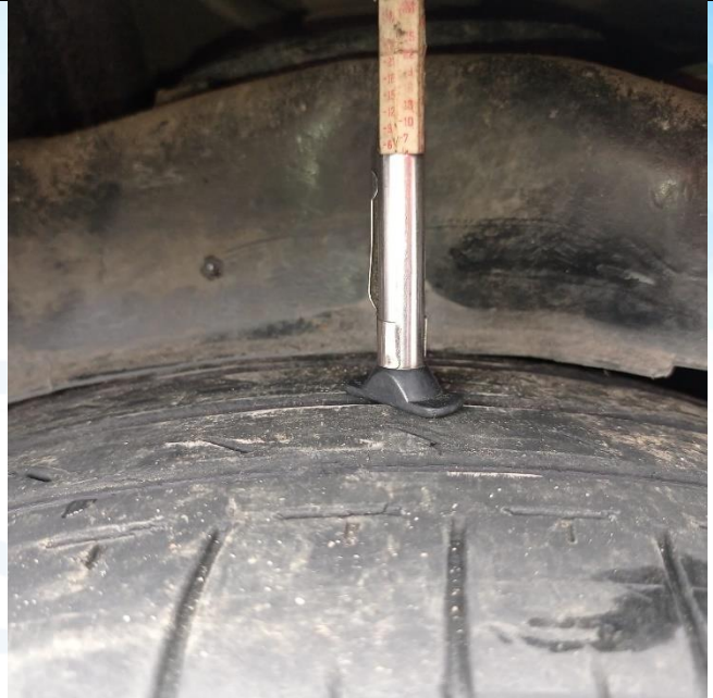
Imagen N° 30: En esta imagen se observa el labrado de la llanta anterior izquierda del vehículo clase Automóvil: Llanta tipo neumática, Según el profundímetro el labrado de la llanta es de 5.1mm en buen estado.
