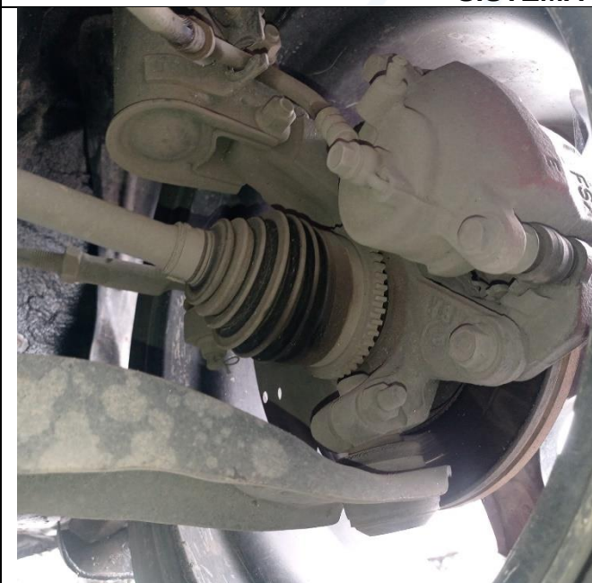
Imagen N° 21: En esta imagen se observa el sistema de frenos, tipo mordaza y disco anterior, izquierdo del vehículo clase Automóvil: Conjunto en buen estado.
