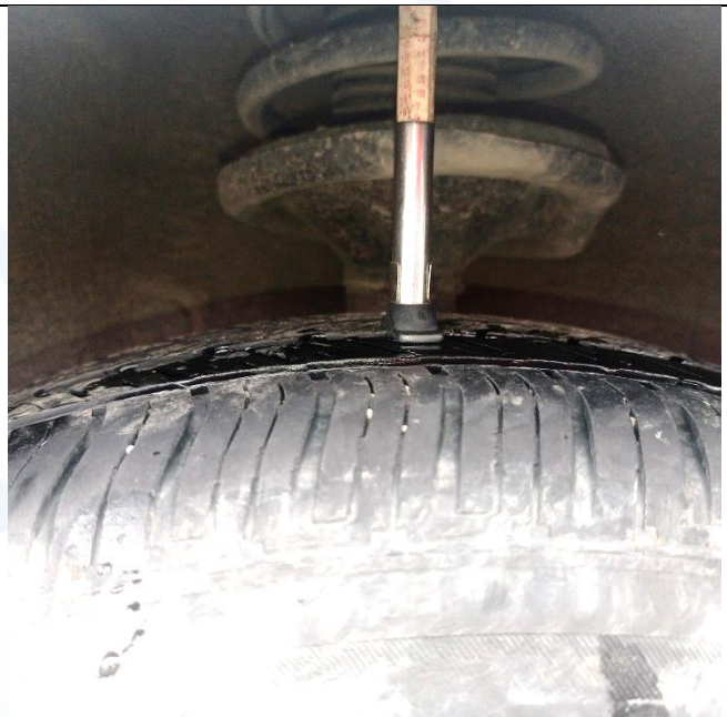
Imagen N° 32: En esta imagen se observa el labrado de la llanta posterior izquierda, del vehículo clase Automóvil: Llanta tipo
