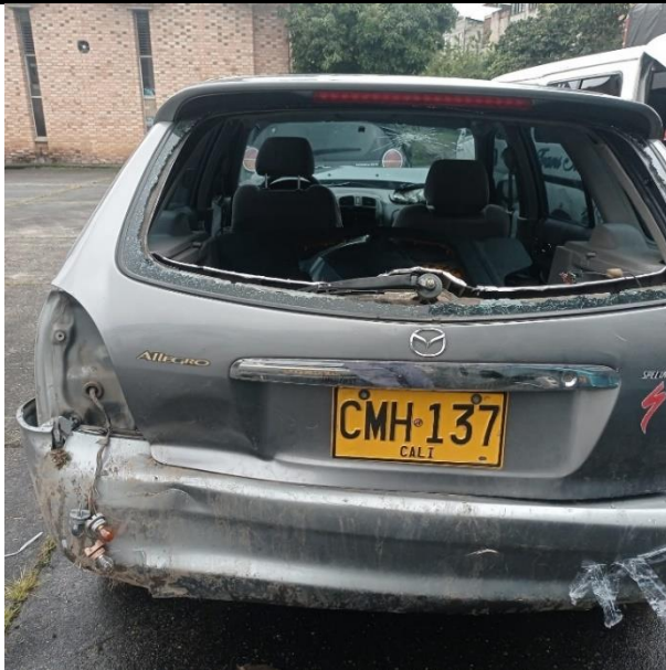
Fotografía número 15 en primer plano: En esta imagen se observa el sistema de alumbrado posterior izquierdo del vehículo, se aprecia desprendimiento en el componente y
