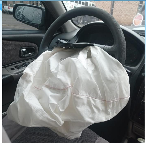
Fotografía número 20 en primer plano: En esta imagen se observa el volante del vehículo, se aprecia activación de la bolsa de aire: Conjunto en mal estado.
