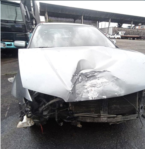
Fotografía número 13 en primer plano: En esta imagen se observa el sistema de alumbrado anterior derecho del vehículo, se aprecia desprendimiento en el componente y desprendimiento de cableado eléctrico: Conjunto en mal estado.
