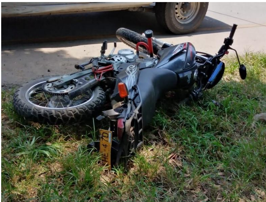
FOTOGRAFÍA No. 5. Plano Medio: Se observan la posición del vehículo No. 2 motocicleta ubicada sobre la zona verde del separador central, esta se encuentra volcada sobre la zona lateral derecha, se evidencian daños en placa y parrilla.
