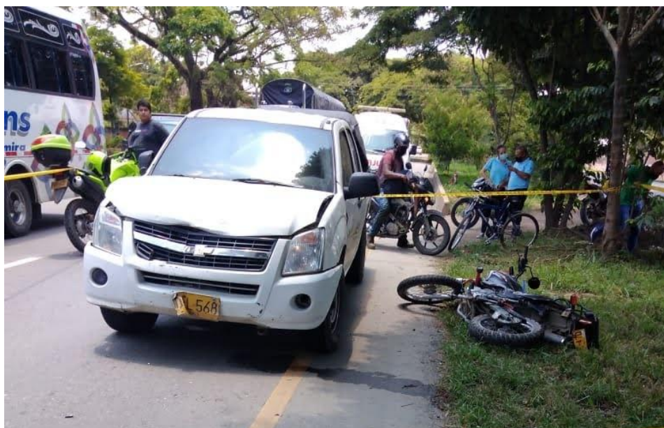
FOTOGRAFÍA No. 6. Plano general: Se observan la posición final de los vehículos, se evidencian daños en la zona anterior del vehículo No. 1 Camioneta (abolladura y englobamiento de capo, doblamiento de placa, rotura de persiana).
