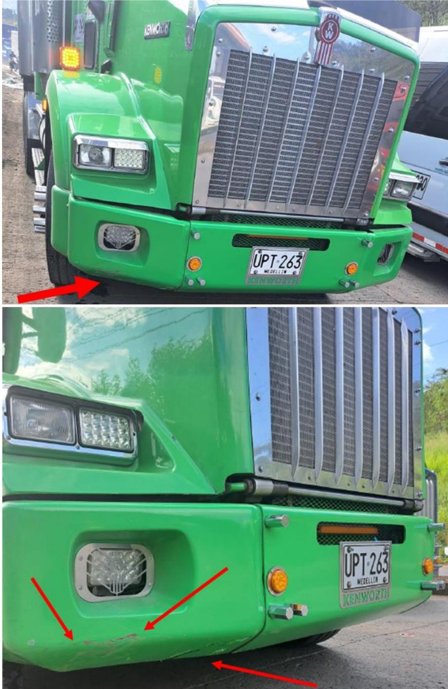
**Imagen No.8:** compuesta por registros del día de los hechos donde se observan los daños en la parte inferior del tercio derecho del paragolpes delantero, compatibles con abrasiones, ausencia de pintura y roces
