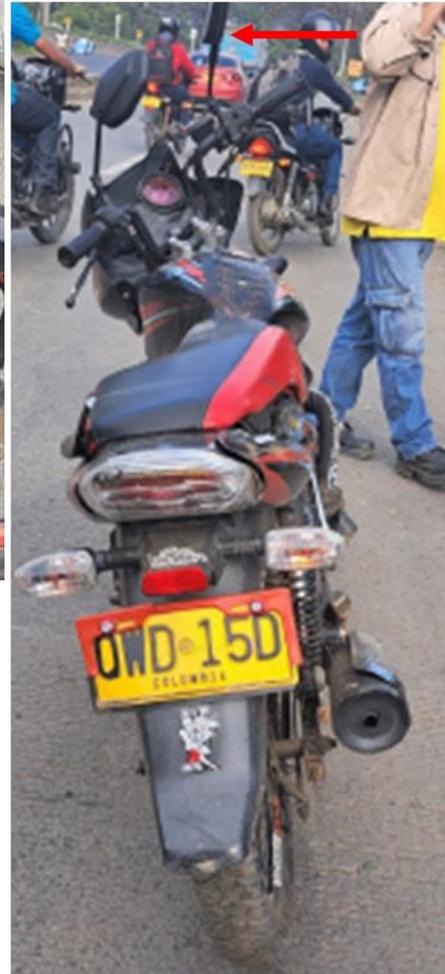
**Imagen No.12:** compuesta por registros del día de los hechos donde se observan daños en el lateral derecho compatibles con abrasiones y desalojo de posapié, rotación de espejos, desalojo parcial del sillín con vestigio de polvo y desplazamiento hacia la derecha del tanque, doblamiento de la defensa derecha hacia atrás.
