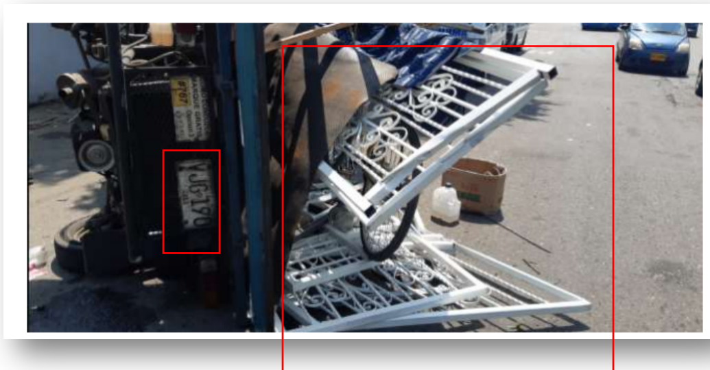
Motocarro de placa VJG-190 con carga de cerrajería que sobrepasa la capacidad de este. Fotografías obtenidas del proceso penal que cursa en la fiscalía 43 local de Cali, bajo el SPOA no. 760016099165201986089
