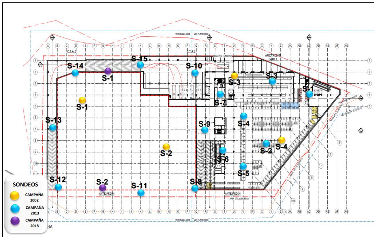
Figura 9. Consolidado de las 3 Campañas de Perforación realizada por EYR en el Proyecto.
