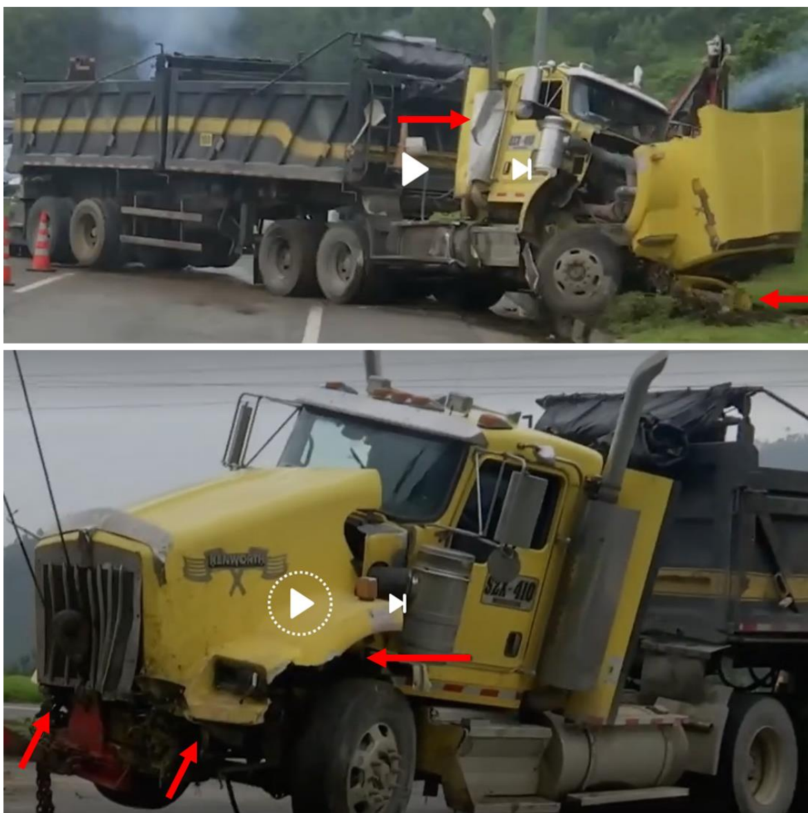
Imagen No.19: compuesta por registros recuperados del día de los hechos donde se observan los daños en la zona frontal del vehículo compatibles con abolladura en parrilla frontal, fractura guardafangos izquierdo, fractura en paragolpes y desalojo de aportes, abolladura el exhosto derecho. Sin un registro detallado de daños y elementos del vehículo se reduce la probabilidad de diferenciar daños por impacto primario con vehículo y daños por interacción con elementos de la vía.
