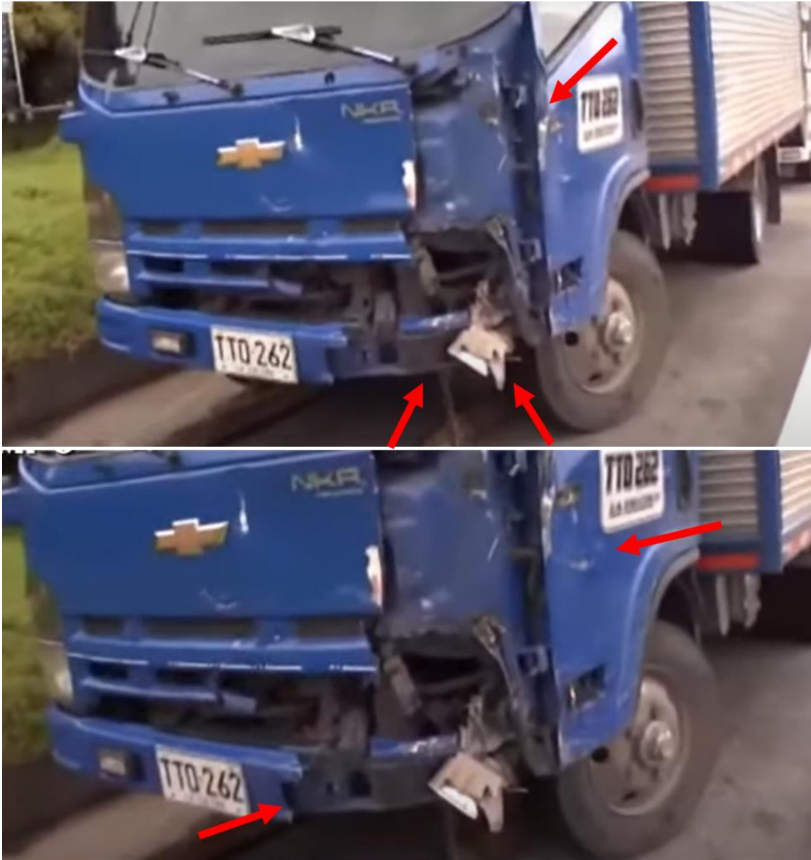
Imagen No.15: compuesta por registros recuperados del día de los hechos donde se observan los daños en el vértice anterior izquierdo de la cabina, abolladura, fractura de paragolpes con desplazamiento hacia atrás, desalojo unidad de luz, desalojo lámina, fractura rejilla frontal, abrasiones en puerta y desalojo luz direccional.
