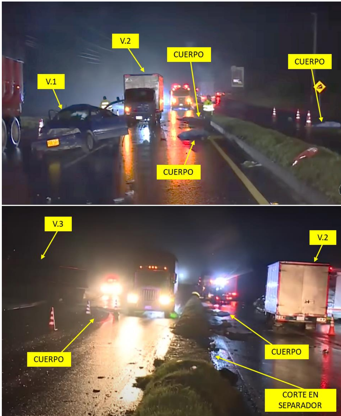
Imagen No.23: registros recuperados del día de los hechos donde se observa la relación entre la posición final de los vehículos, cuerpos, vestigios sobre la calzada, estado de la superficie y condiciones generales de iluminación.
