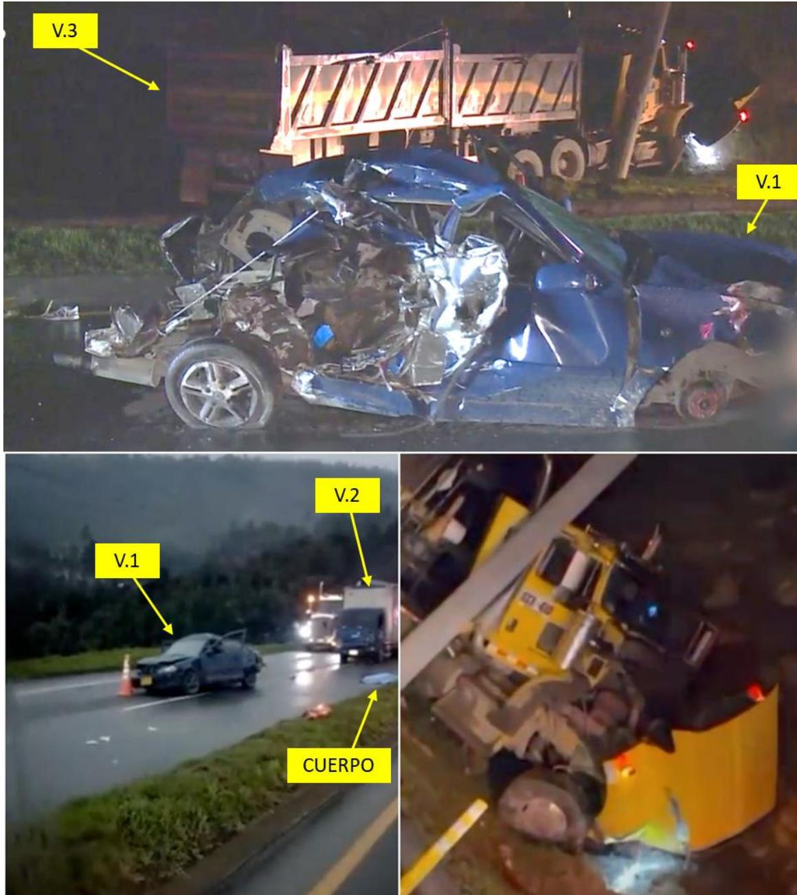
**Imagen No.22:** registros recuperados del día de los hechos donde se observa la relación entre la posición final de los vehículos, cuerpos, estado de la superficie y condiciones generales de iluminación.
