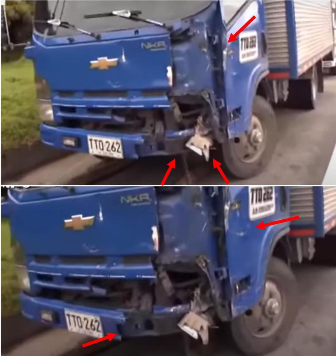
**Imagen No.15:** compuesta por registros recuperados del día de los hechos donde se observan los daños en el vértice anterior izquierdo de la cabina, abolladura, fractura de paragolpes con desplazamiento hacia atrás, desalijo unida de luz, desalijo lámina, fractura rejilla frontal, abrasiones en puerta y desalijo luz direccional.
