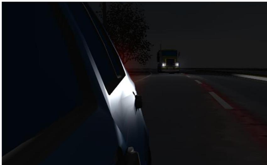
**Imagen No.33:** representación de la visual probable de los conductores 1 y 3 aproximadamente 3 segundos antes de la interacción, ubicación aproximada saliendo de la curva precedente y tiempo no suficiente para reconocer, reaccionar y consumir una maniobra evasiva efectiva. (*t detención total del tractocamión 6segundos*).
