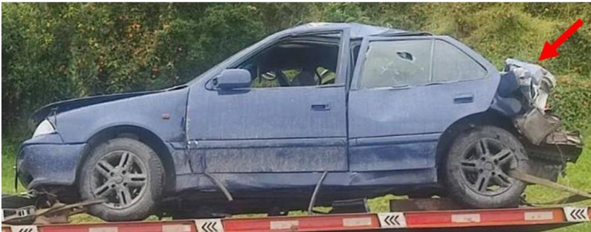
**Imagen No.10:** compuesta por registros recuperados del día de los hechos donde se observan las deformaciones estructurales del vehículo compatibles con desplazamiento de estructura de atrás hacia adelante y hacia la derecha desde la parte posterior hasta el tercio medio del lado derecho, deformación del techo, desalojo llanta delantera derecha, abolladura en tercio anterior lado derecho.
