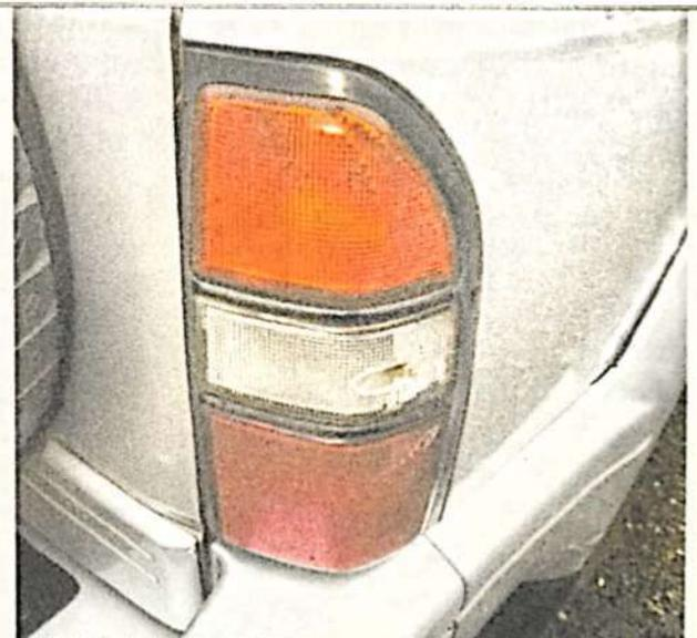
**Fotografía número 14 en primer plano:** En esta imagen se observa el sistema de alumbrado posterior derecho del vehículo tipo CAMPERO de placas OQE-571: Conjunto en buen estado.
