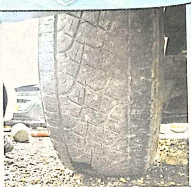
**Fotografía número 32 en primer plano:** En esta imagen se observa el labrado de la llanta posterior izquierda del vehículo CAMPERO de placas OQE-571: llanta tipo neumática, Según el profundímetro el labrado de la llanta es de 8.3mm, en buen estado.
