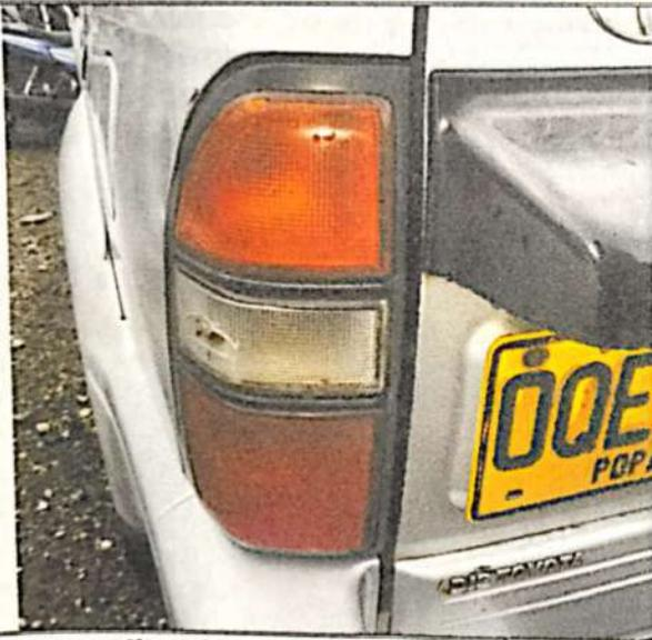
**Fotografía número 13 en primer plano:** En esta imagen se observa el sistema de alumbrado posterior izquierdo del vehículo tipo CAMPERO de placas OQE-571: Conjunto en buen estado.
