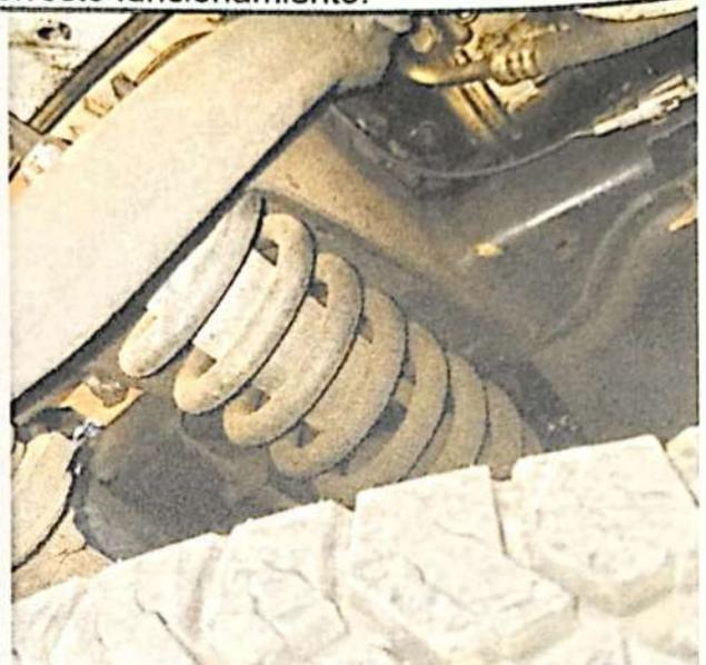
**Fotografía número 21 en primer plano:** En esta imagen se observa el sistema de suspensión tipo helicoidal mecánico e hidráulico anterior izquierdo del vehículo CAMPERO de placas **OQE-571**: Conjunto en buen estado
