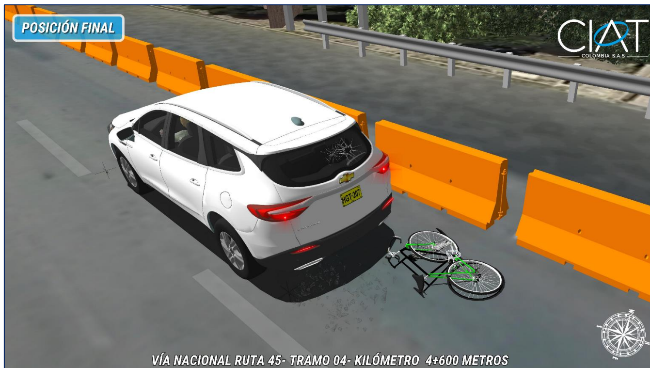
IMAGEN 4. Imagen en 3D, tomada del software de reconstrucción Edge FX. A partir de la nube de puntos obtenida durante la investigación de campo y con base en las evidencias aportadas.
