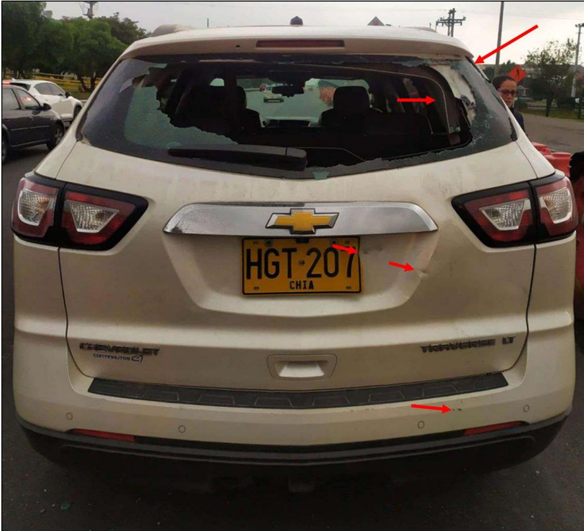
**Imagen No.12:** registro del día de los hechos suministrado por el solicitante donde se observa el estado final de la parte posterior del vehículo, identificando polifragmentación del vidrio de la puerta trasera, abolladuras en tercio derecho de la puerta, desalajo pintura en paragolpes y desalajo parcial de bocel interno de la puerta en zona superior derecha.
