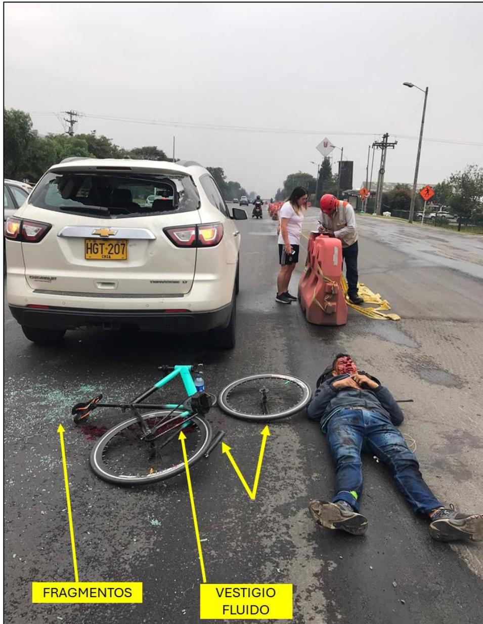
**Imagen No.18:** registro del día de los hechos suministrado por el solicitante donde se observa la posición final de los vehículos, la zona de dispersión y mayor concentración de fragmentos en la vía, la presencia de fluido biológico compatible con sangre bajo la bicicleta, la separación del tenedor y llanta delantera y un estado de reposo del lesionado con evidencia de la lesión en la cara. Se reconoce el funcionamiento de las luces estacionarias.
