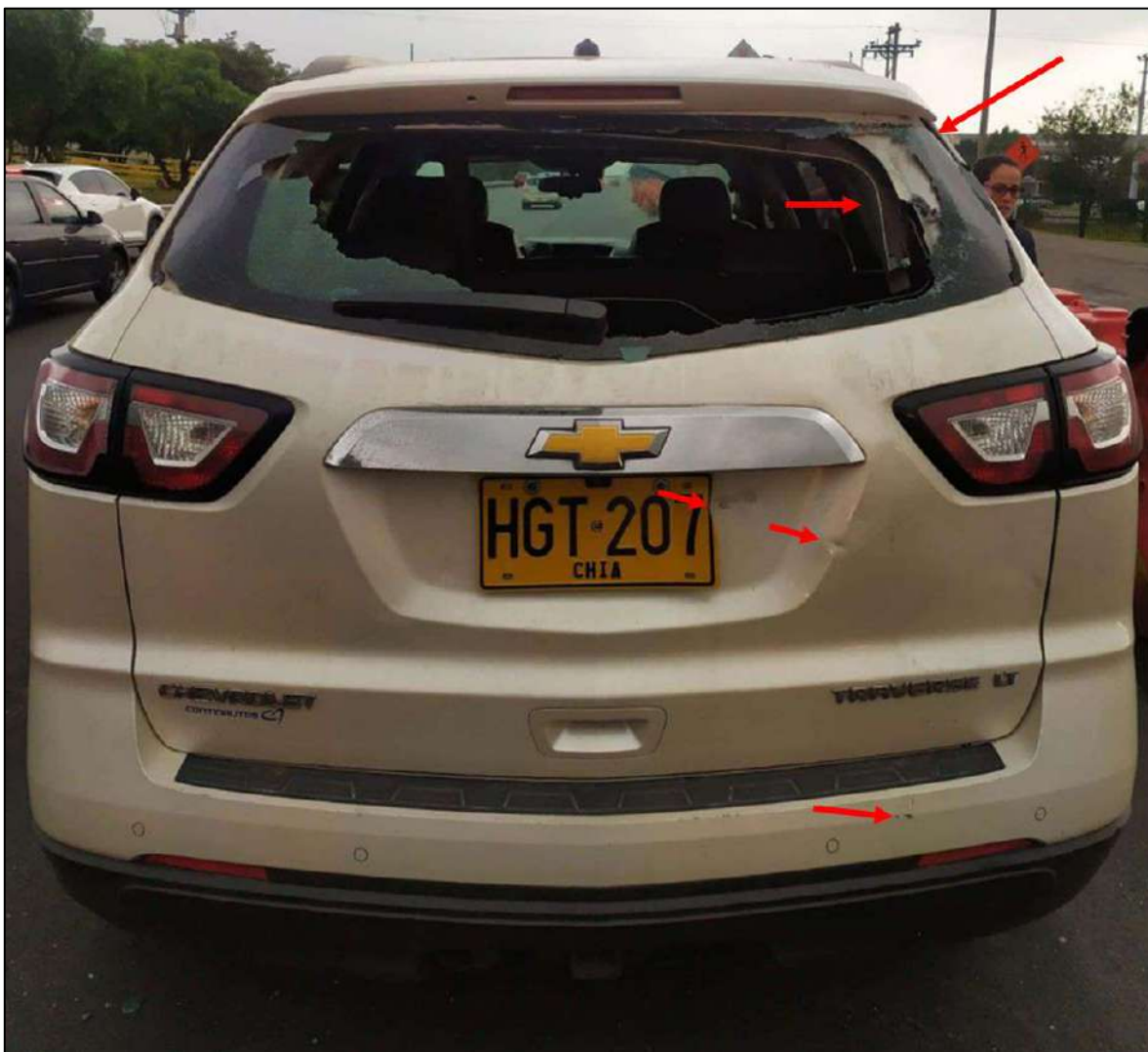
Imagen No.12: registro del día de los hechos suministrado por el solicitante donde se observa el estado final de la parte posterior del vehículo, identificando polifragmentación del vidrio de la puerta trasera, abolladuras en tercio derecho de la puerta, desalojo pintura en paragolpes y desalojo parcial de bocel interno de la puerta en zona superior derecha.
