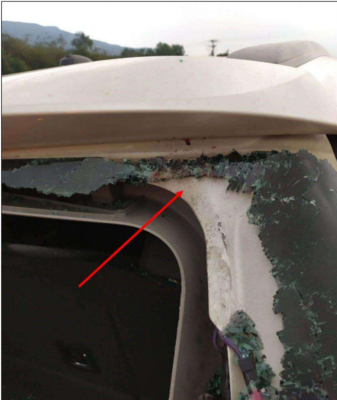
Imagen No.13: registro del día de los hechos suministrado por el solicitante donde se observa en detalle la esquina superior derecha de la puerta trasera, identificando la polifragmentación, abolladura y vestigios color rojo que tendrían compatibilidad con rastros biológicos.
