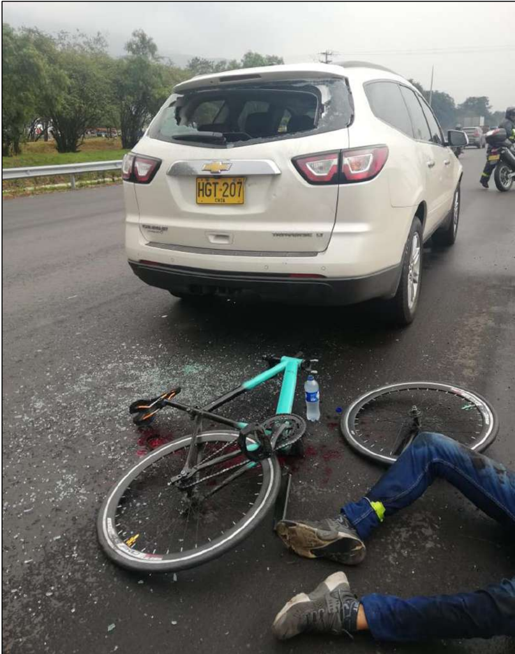
Imagen No.17: registro del día de los hechos suministrado por el solicitante donde se observa la relación entre la posición final de los vehículos, una posición de reposo del lesionado, el estado final de la bicicleta, la zona de dispersión de fragmentos desde antes del eje trasero de la bicicleta y mayor acumulación sobre la zona del sillín y los fluidos de tipo biológico.
