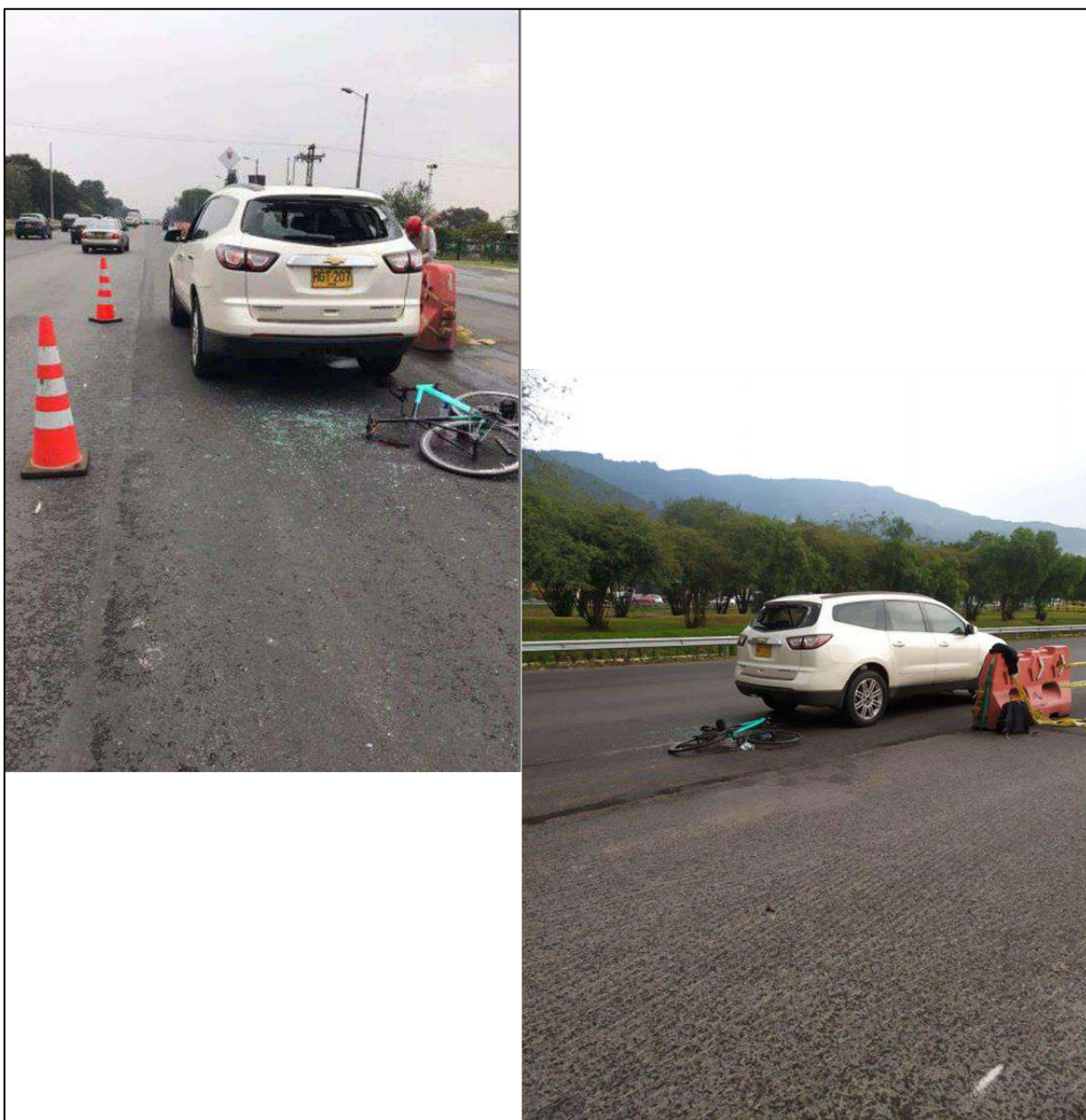
Imagen No.16: Compuesta por registros del día de los hechos suministrados por el solicitante donde se observa la relación entre la posición final de los vehículos como se diagrama en el bosquejo del IPAT, estado de la vía, conos de protección a la escena, las barreras plásticas y la dispersión de fragmentos de video en la superficie.
