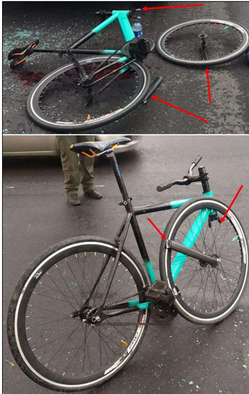
Imagen No.8: compuesta por registros fotográficos del día de los hechos suministradas por el solicitante donde se observa el estado final de la bicicleta, y se identifica la fractura y separación del tenedor en el segmento superior, y desalojo de una pieza de la fijación al rin, dirección con rotación. Se identifica que el sillín tiene una elevación superior respecto del manubrio.
