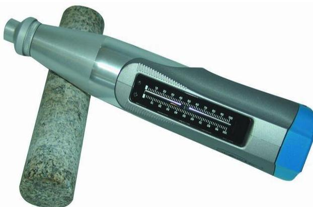
Su uso es muy frecuente dada la manejabilidad del aparato, pudiendo aplicarse sobre roca matriz y fundamentalmente sobre las discontinuidades. Consiste en medir la resistencia al rebote de la superficie de roca ensayada.
