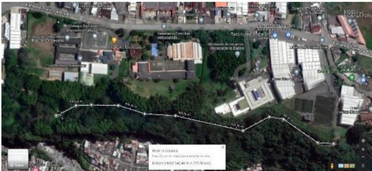
Se realizó el levantamiento topográfico del talud de la avenida del río, Sector de La Badea. En este se incluyó el levantamiento de las cámaras de inspección que hacen parte del colector existente, registrando las cotas bateas de cada salida, y la cota de la tapa de cada cámara de inspección.
