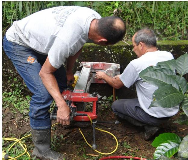
**Figura 222. Registro fotográfico de toma de núcleos de concreto en el canal rectangular de la empresa de energía**
