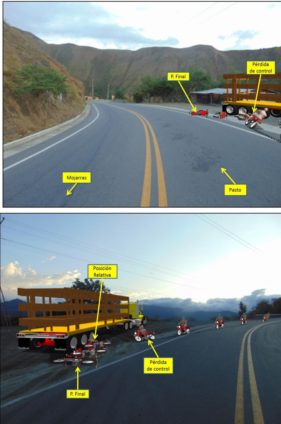
Imagen No. 23: En estas imágenes se observa la secuencia del siniestro, nótese el sentido de desplazamiento de los vehículos, la pérdida de control de la motocicleta y el desplazamiento hasta la posición relativa con el tractocamión.
