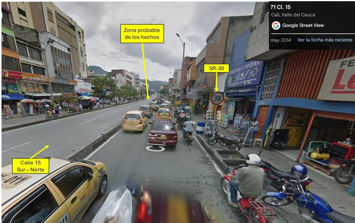
**Fotografía No. 1 Panorámica:** En esta fotografía sustraída de Google Street View (mayo 2014) en sentido sur – norte en la calle 15 entre carreras 8 y 7, se aprecian las características generales de la vía, en la cual se encuentra demarcación horizontal de línea blanca segmentada y líneas de borde, con señalización vertical SR-30 (Velocidad máxima); en este sentido se desplazaba el vehículo No. 1 (Bus).
