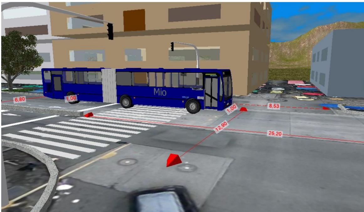
**Imagen No. 11:** En estas imágenes en 3D se observan las evidencias diagramadas en el croquis de la autoridad. Elaboración a escala en el software Trimble Forensics Reveal.
