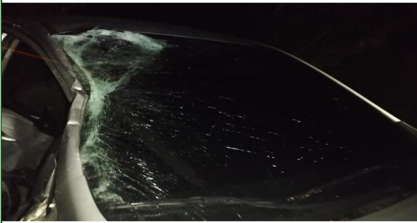
**Fotografía No. 4 Primer Primerísimo Plano:** En esta fotografía complemento de la anterior, se observa el daño de polifragmentación del vidrio panorámico presente en el vehículo No. 1 automóvil, involucrado en el accidente de tránsito.
