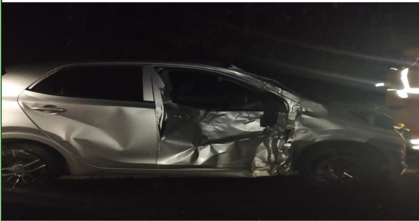
**Fotografía No. 5 Plano Medio:** En esta fotografía complemento de la anterior, se observa el daño (hundimiento puerta acompañante, desalojo del retrovisor derecho) presentes en el vehículo No.1 automóvil, involucrado en el accidente de tránsito.
