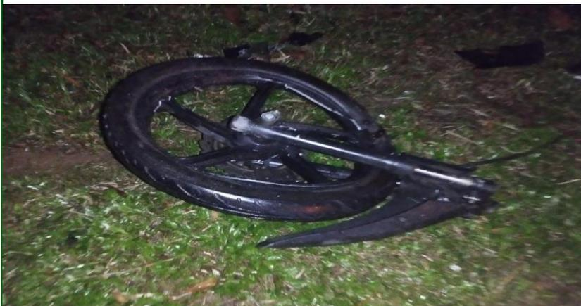
**Fotografía No. 7 Plano Medio:** En esta fotografía complemento de la anterior, se observa las características zona anterior del vehículo No. 2 motocicleta (vehículo que presenta daños dividido en dos partes).
