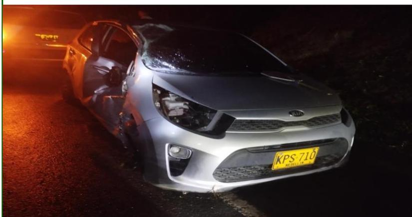
**Fotografía No. 3 Plano General:** En esta fotografía se observan las características generales y daños (desalojo de unidad de luz farola, polifragmentación del vidrio panorámico, hundimiento de la zona lateral derecha) del vehículo No. 1 automóvil, involucrado en el accidente de tránsito.
