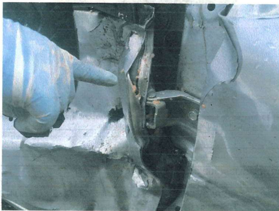
FOTOGRAFIA N° 008 PANORÁMICA: Se ilustra la puerta anterior derecha donde se observa de los siguientes daños hendiduras, hundimiento, deformación, englobamiento y rotura, también se evidencia en el sector de la bisagra donde se observan residuos de tejidos blando.
