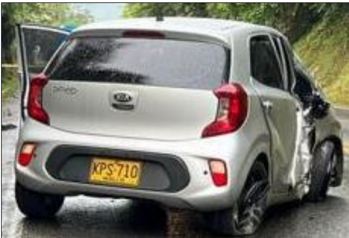
Fotografías No. 3 y 4: En estas fotografías se aprecia el estado final de la zona lateral derecha y zona posterior del automóvil.
