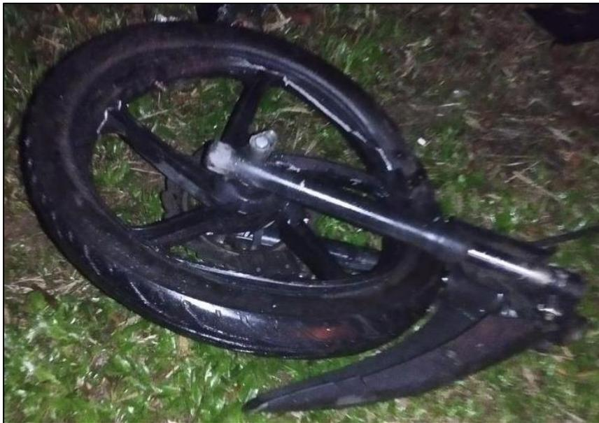
**Fotografías No. 9 y 10:** En estas fotografías se aprecia el desalojo del tren delantero de la motocicleta.
