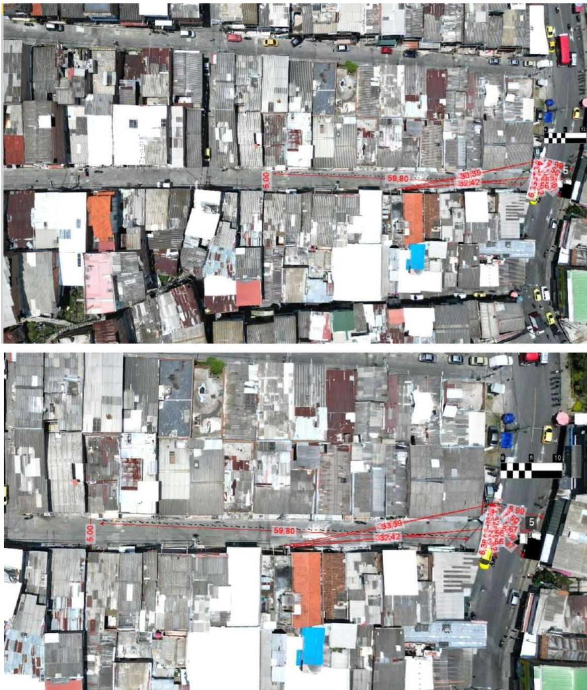
**Imagen No. 28:** En estas imágenes, vista en planta se observan las evidencias diagramadas en el croquis de la autoridad. Elaboración a escala en el software Trimble Forensics Reveal.
