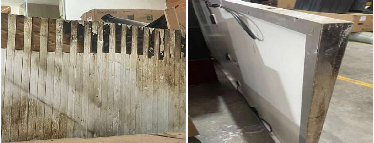
Vista del estado (deformación) de los marcos de aluminio y afectación del anodizado por el calor irradiado
