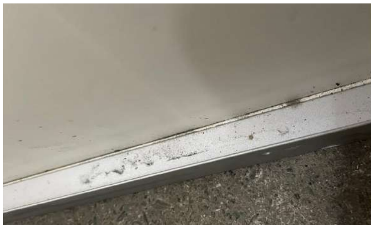
Vista del backsheet y marco de aluminio afectados por la irradiación de calor
