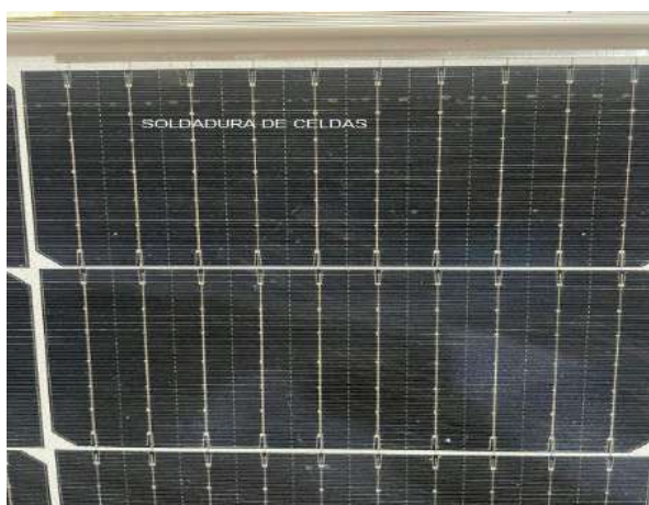
Vista del estado de las soldaduras de las celdas con desprendimiento de los puntos y deformación del junction box por el calor irradiado
