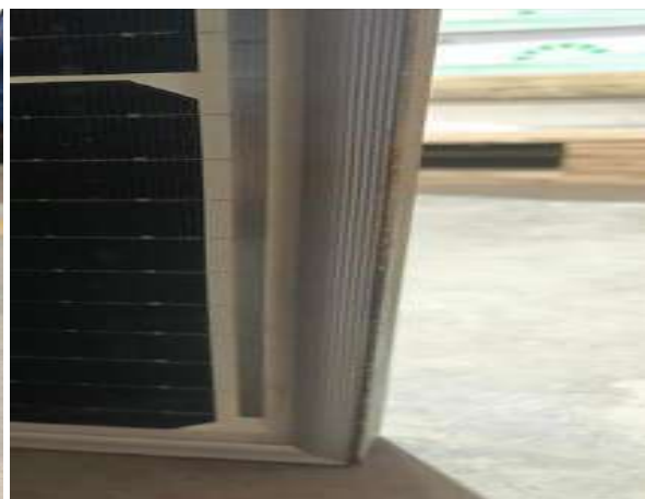
Vista del estado (deformación) de los marcos de aluminio por el calor irradiado e impactos al caerse de los pallets en el momento que quedaron sin seguridad
