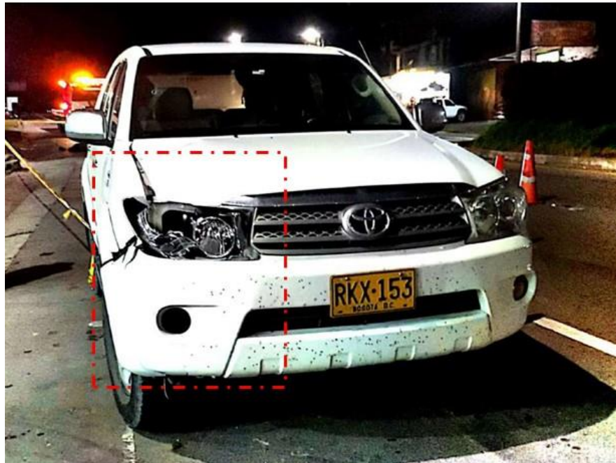
Fotografía No.6: En esta fotografía compuesta por fotografías del día de los hechos se observa los daños presentes en el vértice anterior y costado derecho del Campero, afectando piezas como; guardabarro anterior derecho, persiana, bómper anterior, capot y la unidad de luz.
