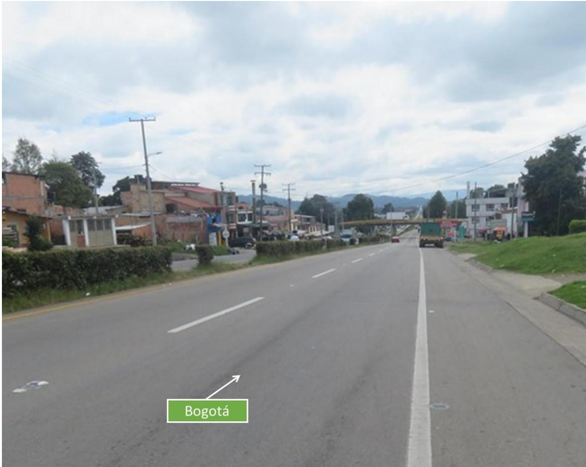
**Fotografía No.1 Panorámica:** En esta fotografía tomada por el equipo de IRS Vial en sentido La Vega – Bogotá a la altura del km 21 + 800 m, se aprecian las características generales de la vía, en la cual se encuentra demarcación horizontal de línea separadora de carril blanca segmentada, líneas de borde amarilla – blanca; en este sentido se desplazaba el vehículo No.1 Campero.
