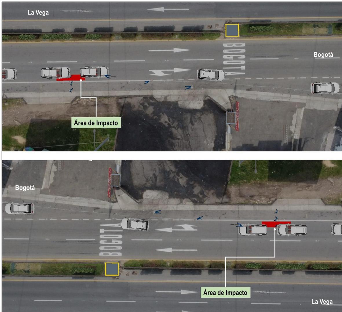
**Imagen No. 19:** En estas imágenes, vista en planta y 3D se aprecia la secuencia del siniestro antes y al momento del impacto, nótese el sentido de desplazamiento del vehículo y la posición relativa sobre la calzada.
