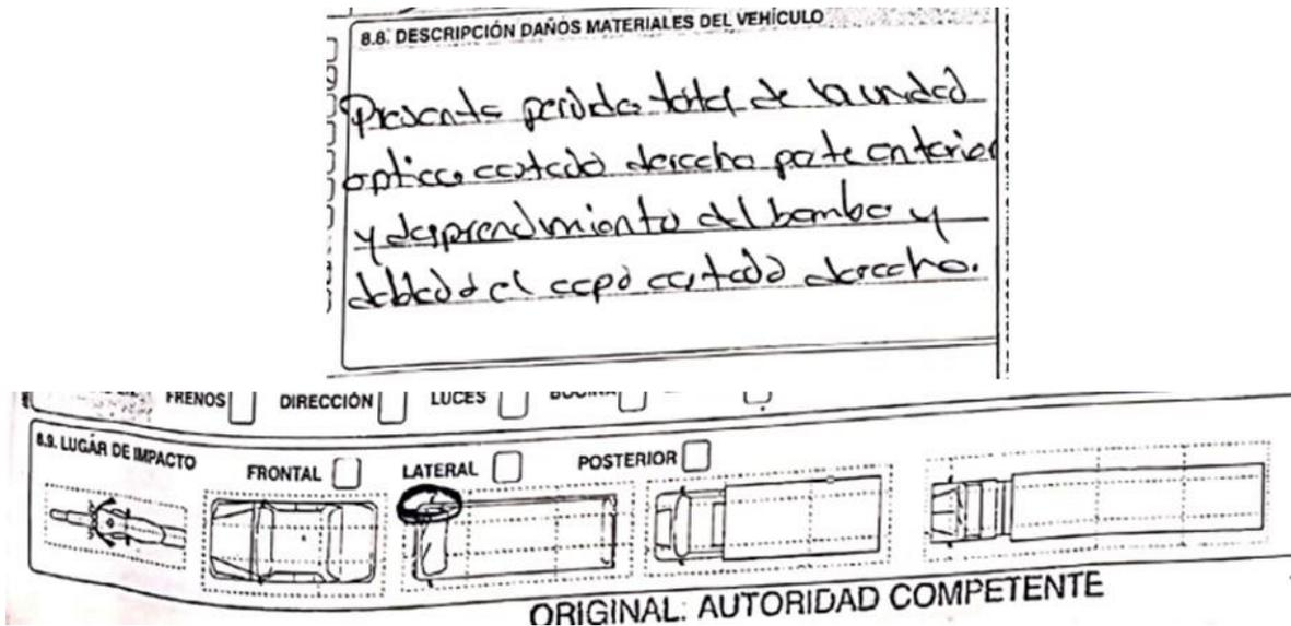
**Imagen No.7:** En esta imagen se observa el diagrama del informe de la autoridad, donde hacen referencia a la zona de daños y descripción de los mismos, *“Presenta perdida total de la unidad óptica costado derecho parte anterior y desprendimiento del bómper y doblado del capot costado derecho”*
