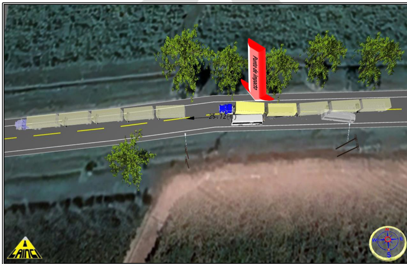
Imagen 06 Fuente software ARAS 360 HD, Reconstrucción y modelación Ing. Rommy Schnaider Cano, visual del instante de colisión y se evidencia área de choque en el primer y segundo tercio lateral izquierdo del bus. Topografía, plano y condiciones climáticas similares. Edición Ing. Rommy Schnaider Cano. Punto de impacto localizado por los daños presentes en los vehículos. plano escala 1:1 vista superior a 200 metros de altura.
