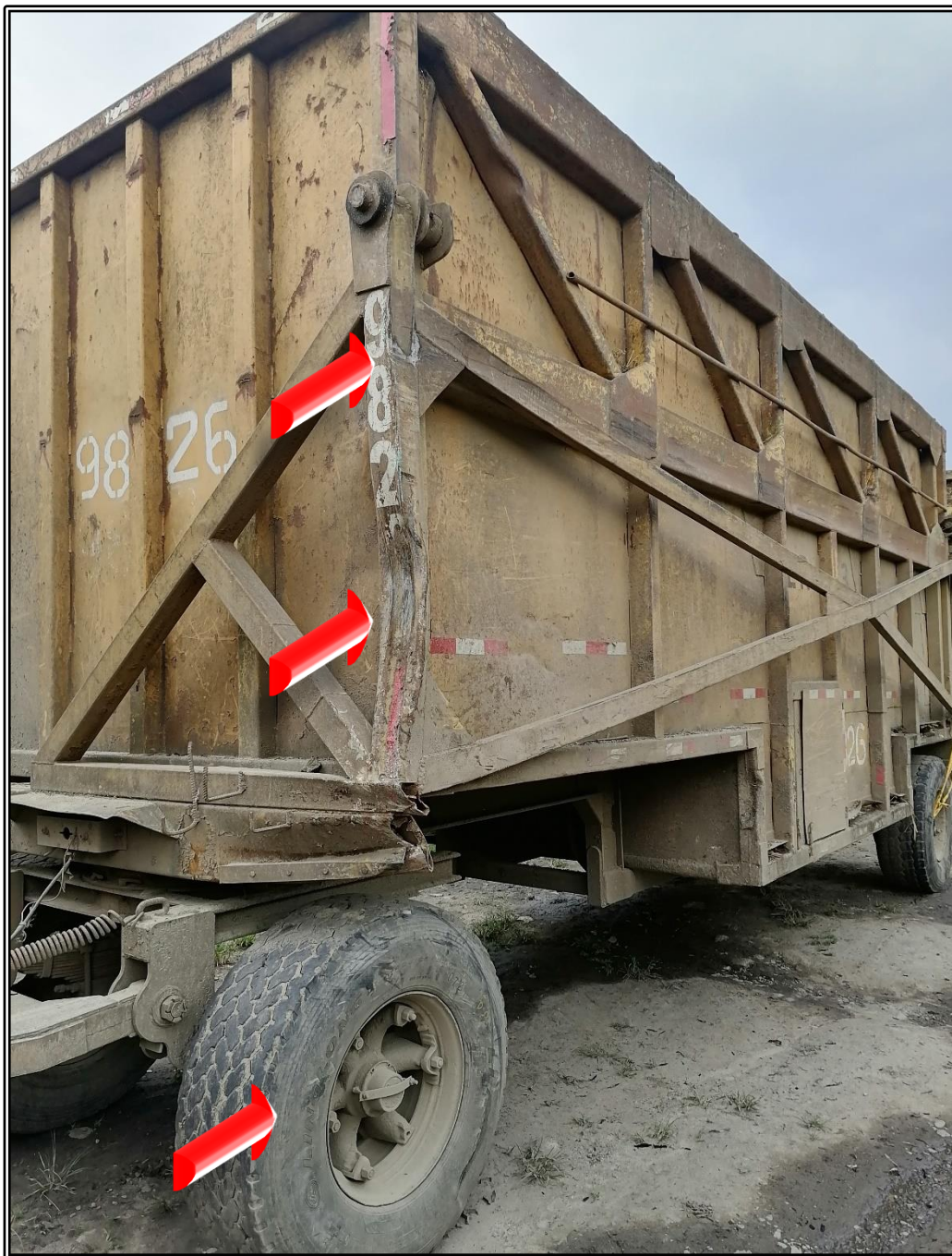
Imagen 05 Fuente Dr. Jose Jimenez, Edición Ing. Rommy Schnaider cano, identificación del vehículo tracto camión de placa WRD148 participante en el accidente de tránsito, segundo impacto, vagón N°2(9826) primer tercio anterior izquierdo. Huellas de contacto sobre el neumático y sobre el perfil de giro del vagón.
