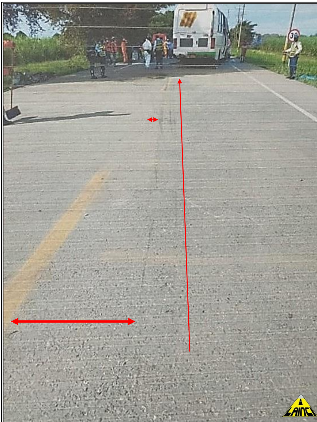
Imagen 03 Fuente Dr. Jose Jimenez, Edición Ing. Rommy Schnaider cano, identificación de huella de arrastre neumático del eje anterior izquierdo del bus de placa CBQ098, participante en el accidente vial, huella presente sobre el carril de circulación del bus y al acercarse al punto de impacto, este se aproxima al centro del carril.
