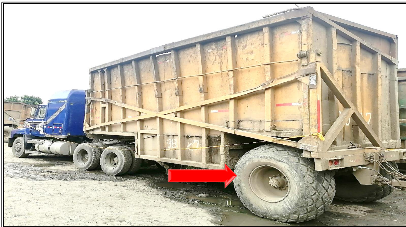
Imagen 04 Fuente Dr. Jose Jimenez, Edición Ing. Rommy Schnaider cano, identificación del vehículo tracto camión de placa WRD148 participante en el accidente de tránsito, primer impacto, vagón N°1(9827) primer tercio posterior izquierdo. Huellas de contacto sobre el neumático flotante.
