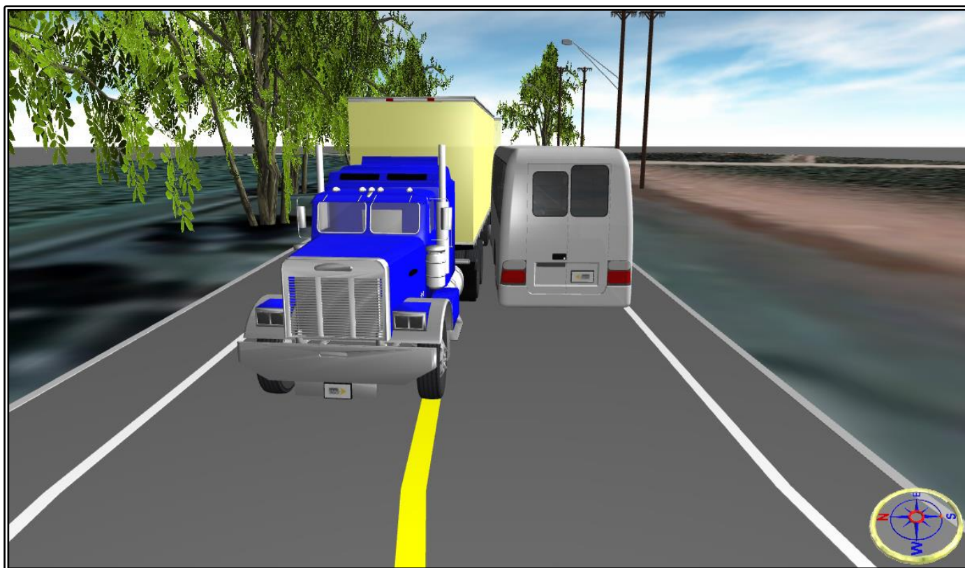
Imagen 09 Fuente software ARAS 360 HD, Reconstrucción y modelación Ing. Rommy Schnaider Cano, visual del instante de colisión. Topografía, plano y condiciones climáticas similares. Edición Ing. Rommy Schnaider Cano. Punto de impacto localizado por los daños presentes en los vehículos. plano escala 1:1 desde la perspectiva de una visual. 1:100
