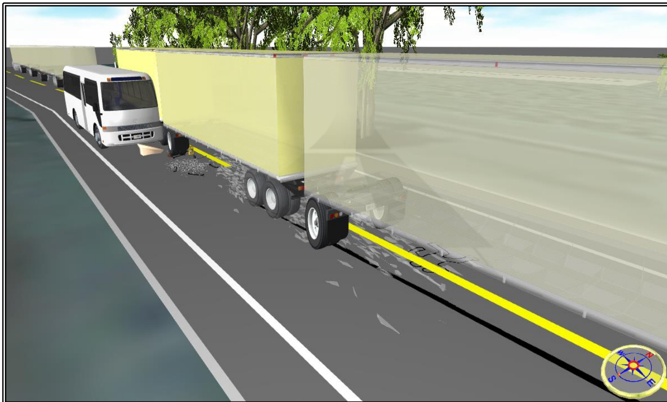
Imagen 10 Fuente software ARAS 360 HD, Reconstrucción y modelación Ing. Rommy Schnaider Cano, visual del instante de colisión. Topografía, plano y condiciones climáticas similares. Edición Ing. Rommy Schnaider Cano. Punto de impacto localizado por los daños presentes en los vehículos y elementos físicos en la vía. plano escala 1:1 desde la perspectiva de una visual. 1:100
