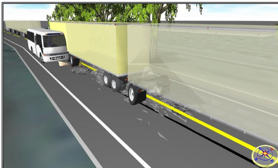
Imagen 10 Fuente software ARAS 360 HD, Reconstrucción y modelación Ing. Rommy Schneider Cano, visual del instante de colisión. Topografía, plano y condiciones climáticas similares. Edición Ing. Rommy Schneider Cano. Punto de impacto localizado por los daños presentes en los vehículos y elementos físicos en la vía. plano escala 1:1 desde la perspectiva de una visual. 1:100
