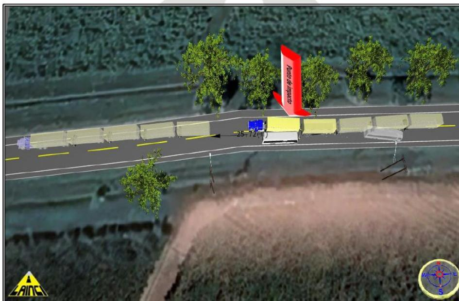
Imagen 06 Fuente software ARAS 360 HD, Reconstrucción y modelación Ing. Rommy Schnaider Cano, visual del instante de colisión y se evidencia área de choque en el primer y segundo tercio lateral izquierdo del bus. Topografía, plano y condiciones climáticas similares. Edición Ing. Rommy Schnaider Cano. Punto de impacto localizado por los daños presentes en los vehículos. plano escala 1:1 vista superior a 200 metros de altura.
